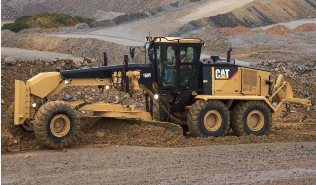
**Figura 31: Motoniveladora 16m**
