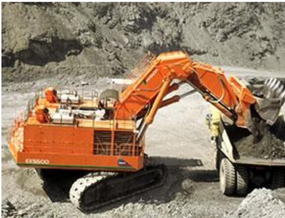
Figura 28 - Hitachi Modelo EX5500-5 de 27m<sup>3</sup> em produção.
