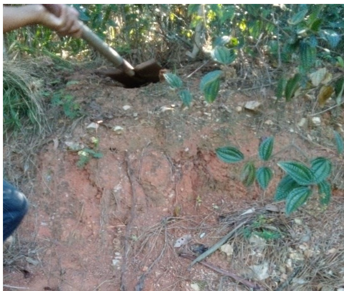
Figura 8 - Coleta de amostra de solo com auxílio de pá
