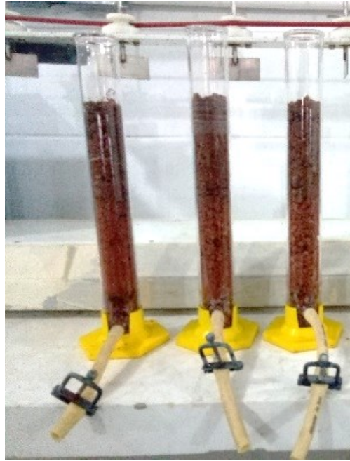
Figura 15 – Provetas preenchidas com as camadas de Solo
