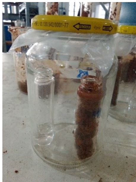
Figura 20 – Frasco com amostra de solo do filtro e o outro frasco com NaOH
