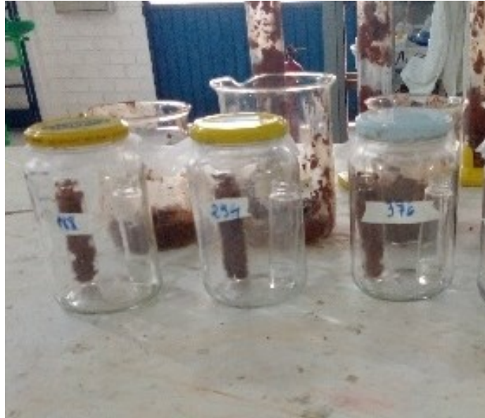
Figura 21 – Frascos com o solo proveniente dos filtros utilizados durante as 8 semanas de experimento
