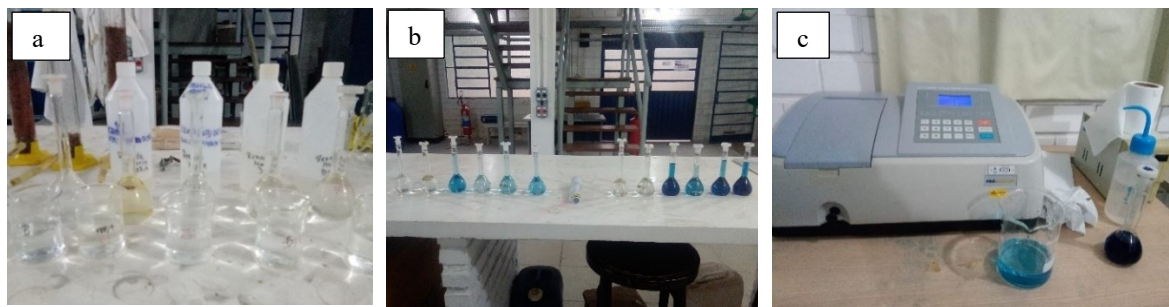
Figura 19 – Procedimento de análise de ortofosfato: (a) Execução do procedimento de análise de ortofosfato; (b) Amostras de fósforo total e ortofosfato prontas para análise de cor no equipamento e (c) Espectrofotômetro utilizado nas análises de ortofosfato e fósforo total
