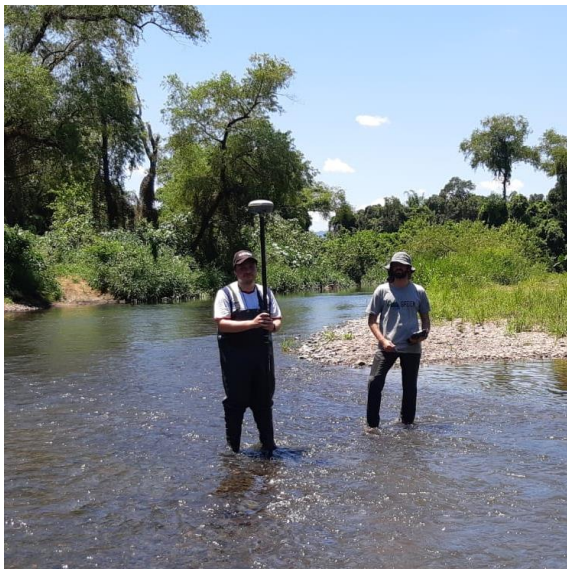
Figura 26. Levantamento Topográfico Seção P9
