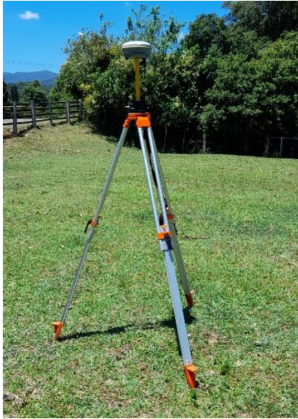
Figura 20. Base coletora do RTK.
