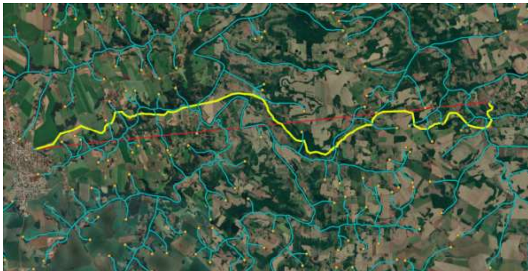
Figura 29 Interferência em cursos d'água existente, traçado 3 FONTE: QGIS.
