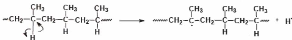
Figura 9: Mecanismo de quebra homolítica da. As flechas são apenas ilustrativas e representam a transferência de um elétron da ligação para os átomos em uma cisão homolítica de ligação C-H. Fonte: (De Paoli, 2008)
