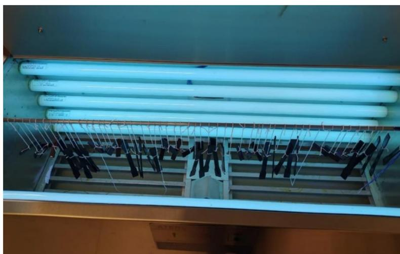
Figura 16 – Imagem interna da câmara UV utilizada para o envelhecimento acelerado. Fonte: do autor
