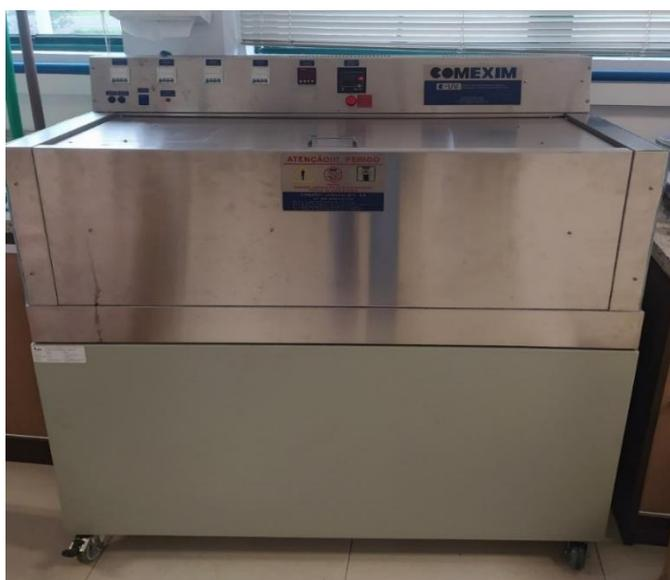
Figura 15 – Câmara UV utilizada para o envelhecimento acelerado. Fonte: do autor
