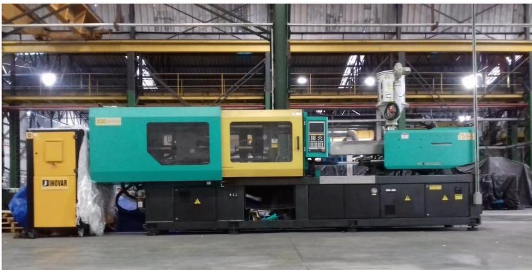
Figura 14: Máquina injetora Log Machine 250.
