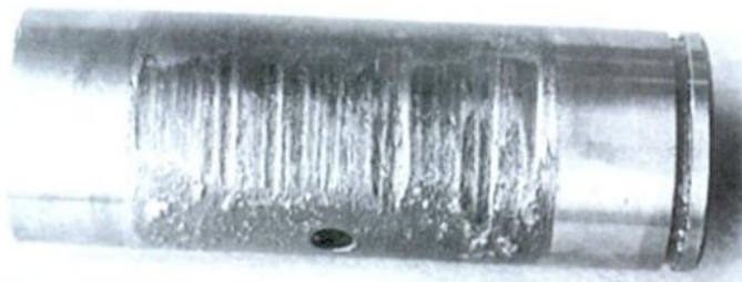
Figura 2: Escoreamento gerado por desgaste adesivo (NORTON, 2004).
