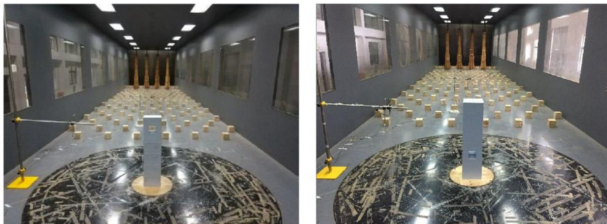
Figura 33 – Modelos ensaiados em túnel de vento
