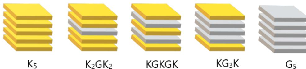
**Figura 16 – Sequência de empilhamento e nomenclatura usada para os compósitos. (ARTIGO I)**
