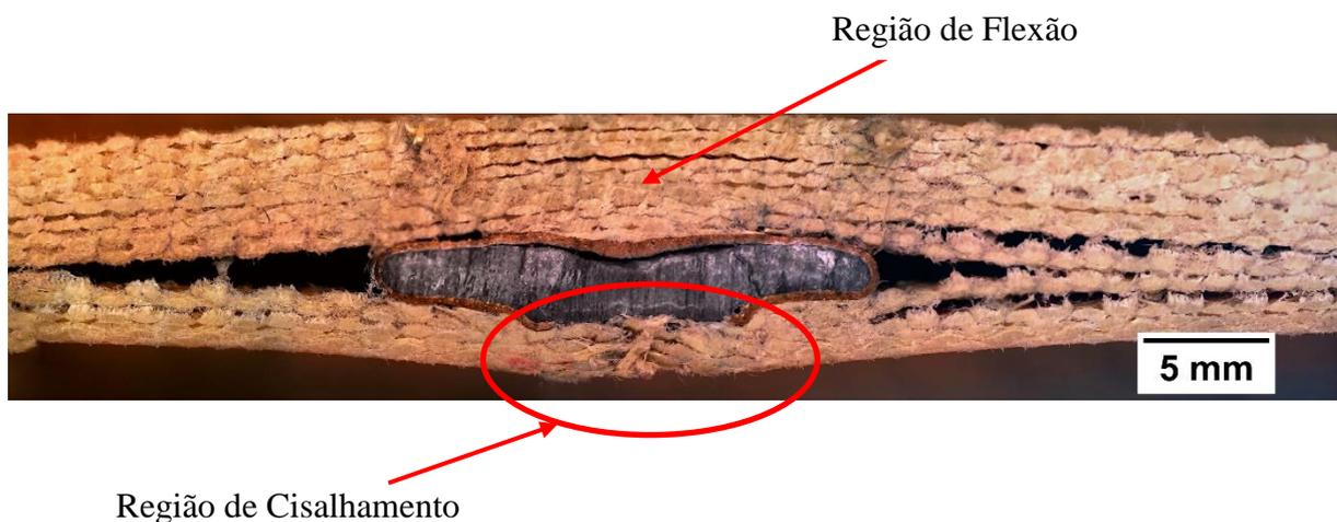
**Figura 27 – Regiões de cisalhamento e flexão durante a penetração/retenção do projétil**
