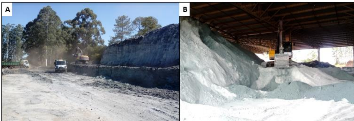
Figura 2 - Armazenagem de dregs . Área aberta (A). Pavilhão (B).
