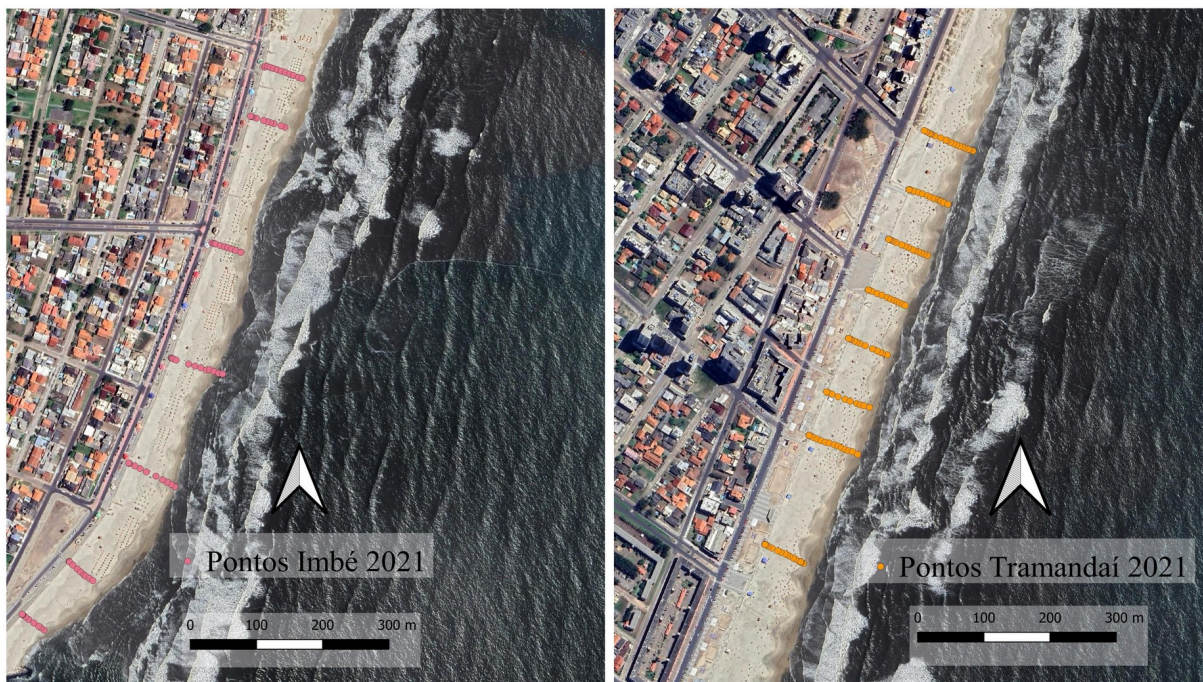
Figura 19 – Pontos levantados em forma de perfis transversais à linha d'água nas prais de Imbé e Tramandaí, respectivamente, em 2021.
