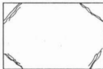
Figura 24 - Fissuras na face superior de uma laje simplesmente apoiada provocada pelos momentos volventes
