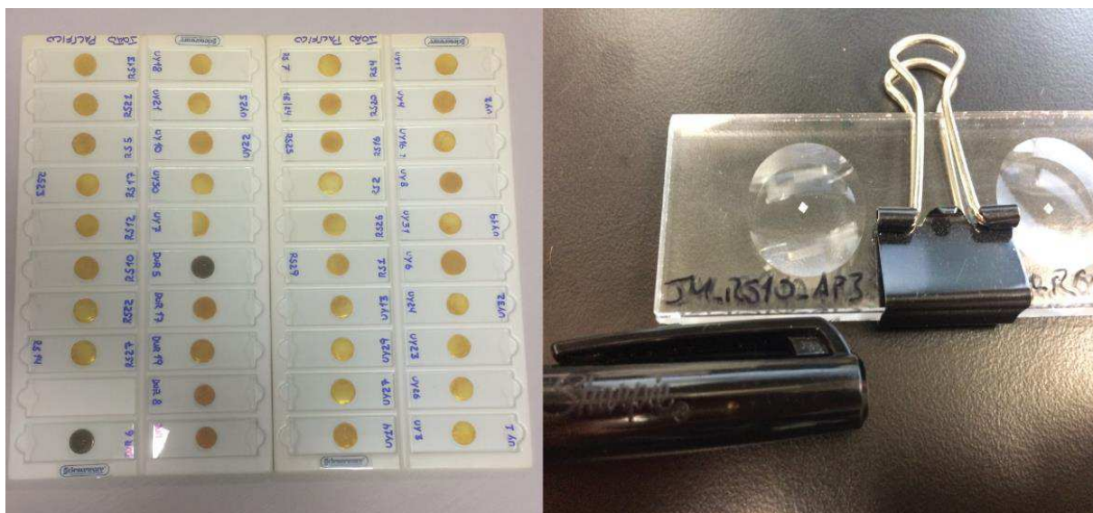
Figura 3.3: Materiais para análise de termocronometria. À esquerda, conjunto de pastilhas com aproximadamente 400 cristais cada para análise dos traços de fissão de apatita. À direita, dois cristais de apatita embalados individualmente em tubos de Nb para análise (U-Th)/He.
