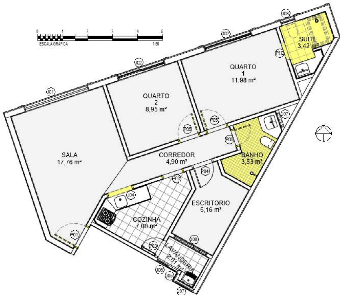
Figura 16 - Planta baixa com os elementos removidos em destaque
