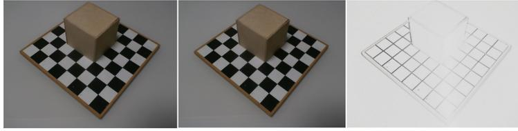
**Figura 15:** Aplicação da compensação das distorções. Na esquerda, imagem obtida pela câmera. No centro, imagem com compensação de distorções radiais e tangenciais aplicada. Na direita, diferença entre as imagens com contraste ajustado para realçar.
