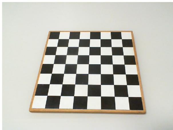
**Figura 11:** Padrão xadrez utilizado para calibração (arestas dos quadros com 22,5 mm).
