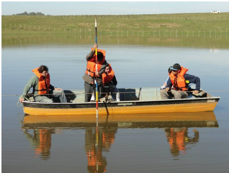
Figura 2: Realização de levantamento batimétrico por vara graduada.
