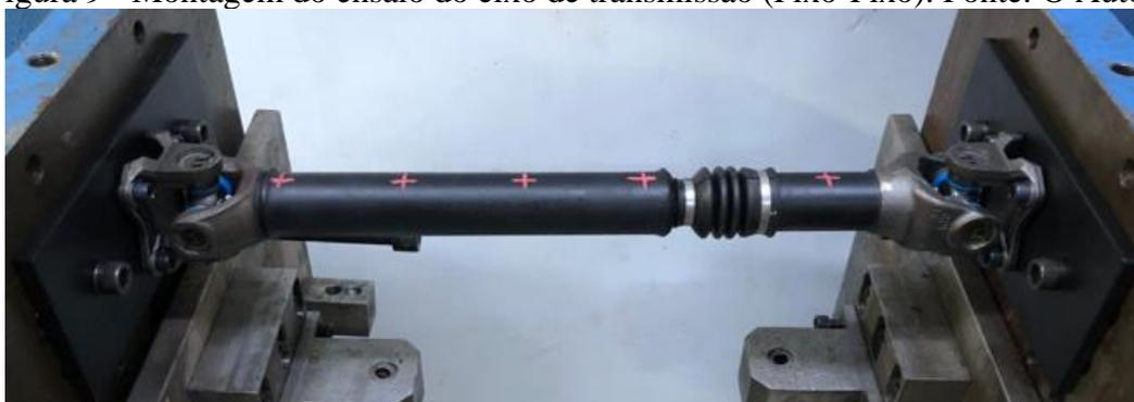
Na aba *Impact Setup*, do LMS SCADAS, é feita a adequação do sistema completo, ou seja, configuração original do eixo, acelerômetro, martelo e os suportes de fixação. Nesta etapa, são impressas algumas batidas com o martelo sobre o eixo para que haja uma adequação da montagem em relação às batidas e às respostas de aceleração. A Figura 10 mostra o decremento da resposta de amplitude associada à essa adequação do sistema.
