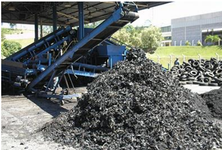
Figura 3.13 – Processo típico de granulação por recuperação de pneus inservíveis
