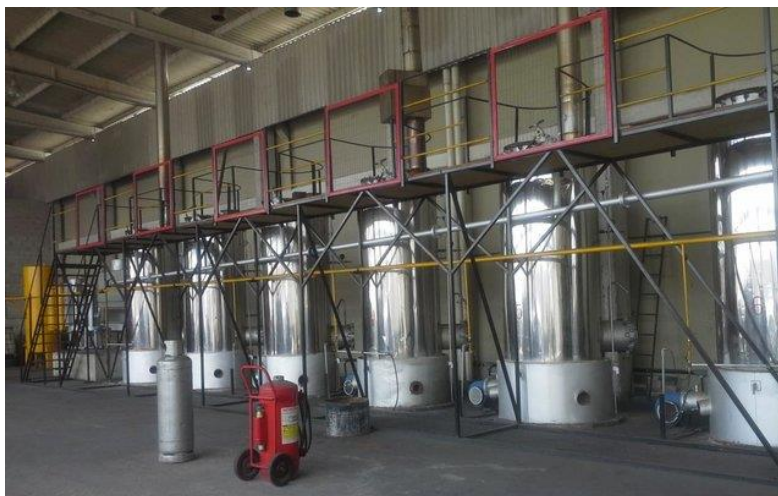
Figura 3.14 - Planta típica de pirólise de pneus inservíveis
