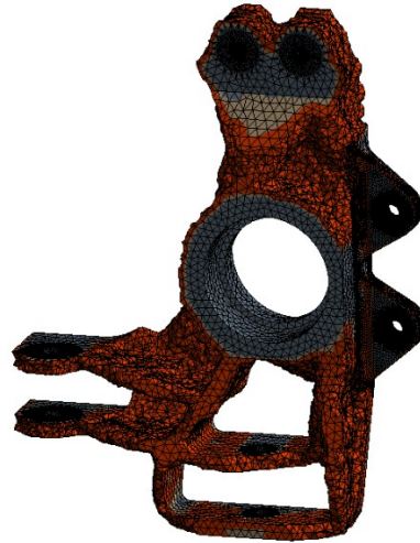
Figura 8 – Resultado bruto da simulação de otimização estrutural. (Fonte: a autora)
