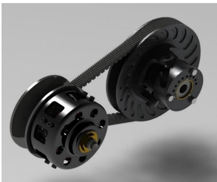
Figura 13. Modelo de CVT utilizado pela equipe. Fonte: IJEAP (2021)
