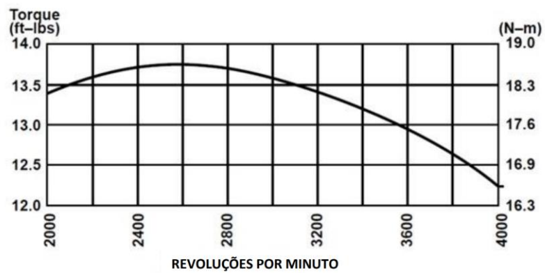
Figura 12. Curva de torque do motor utilizado pela equipe. Fonte: Briggs & Stratton do Brasil (2013).
