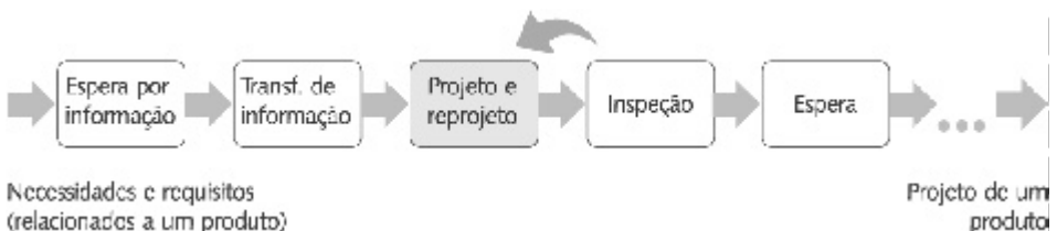
Figura 2 – Modelo de fluxo do processo de projeto (HUOVILA et al., 1997)
