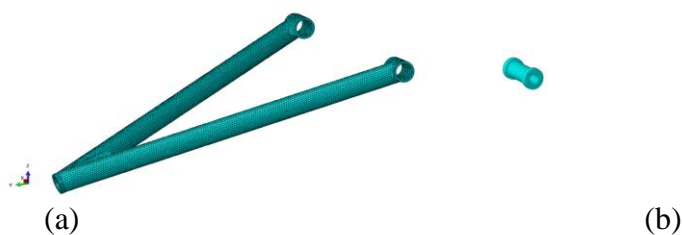
Figura 26 – (a) Malha da balança superior. (b) Malha da bucha da balança superior
