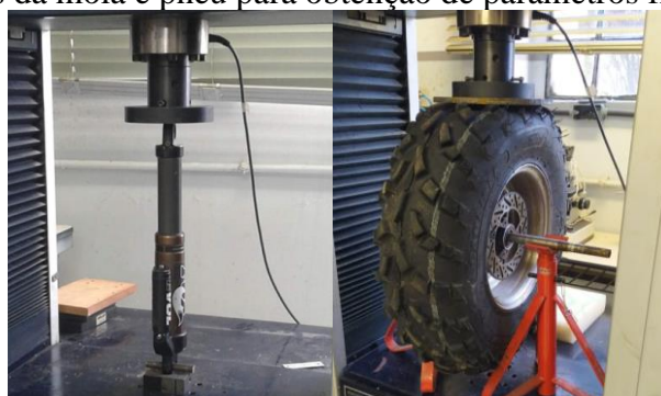
Figura 5 – Ensaio da mola e pneu para obtenção de parâmetros físicos. Fonte: Autor
