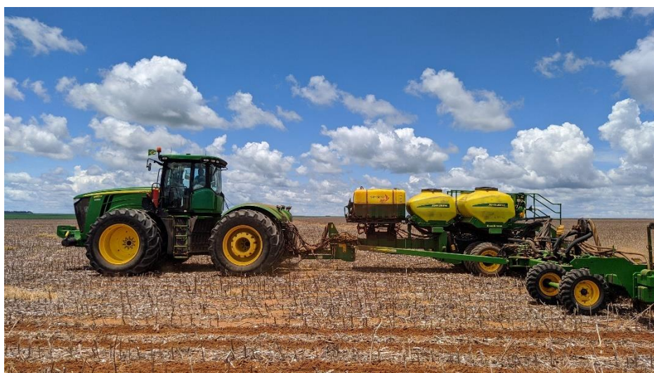
Figura 4. Conjunto formado por trator John Deere 9510R + semeadora DB 50 Exact Emerge, durante a realização da semeadura da cultura da soja.
