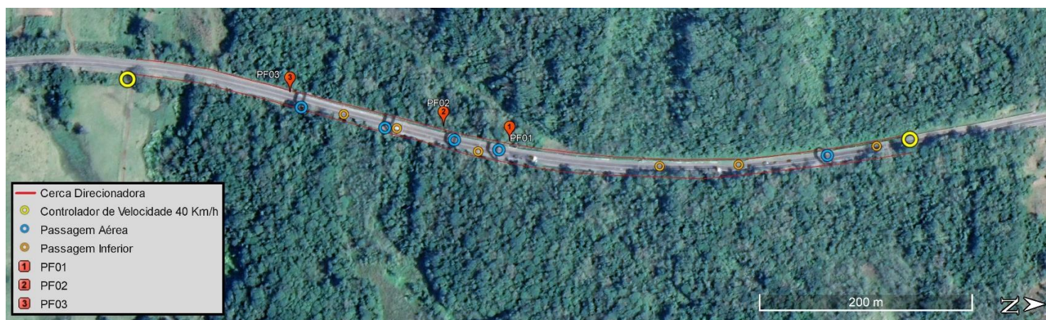
Figura 2. Localização das passagens de fauna do tipo pontilhão (PF) e das medidas mitigadoras complementares implantadas no trecho em que a rodovia ERS-486 (Rota do Sol) transpassa a RBMP, município de Itati, nordeste do Rio Grande do Sul, Brasil.
