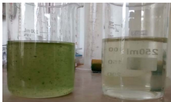
Figura 3. Aflente e eflente do sistema de separação sólido/líquido(FAD), utilizando o Tanfloc SG.
