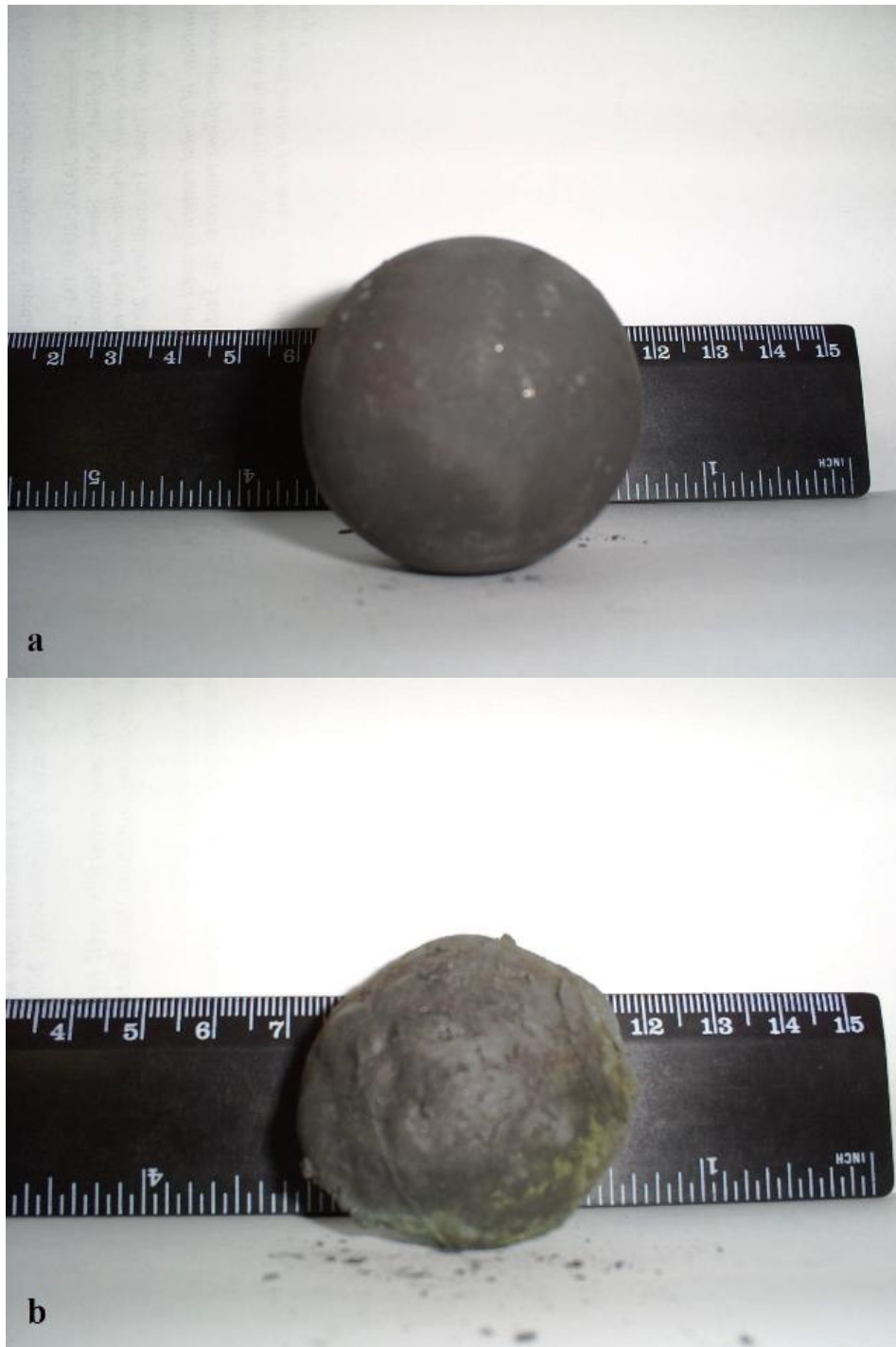
Figura 5.20. Revestimentos obtidos por GC, antes (a) e após (b) sinterização a 2000°C.
