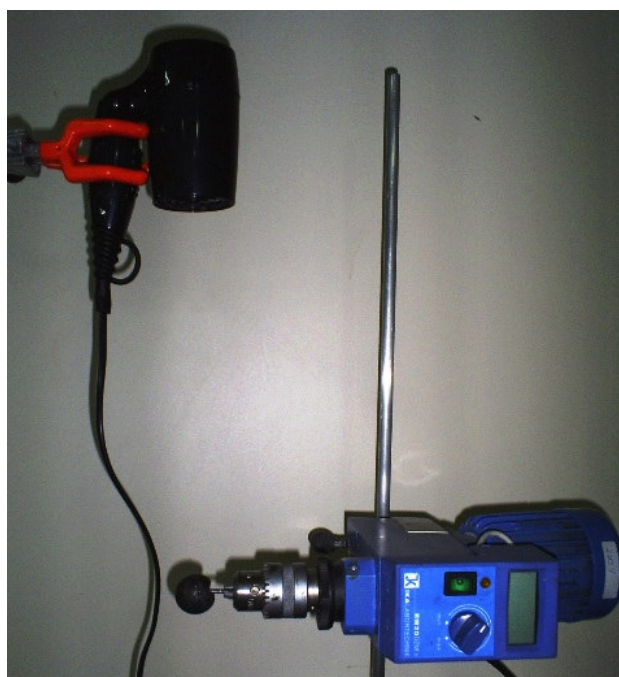
Figura 4.4. Sistema montado para a obtenção de recobrimento das esferas por processo Hot Spin Coating .
