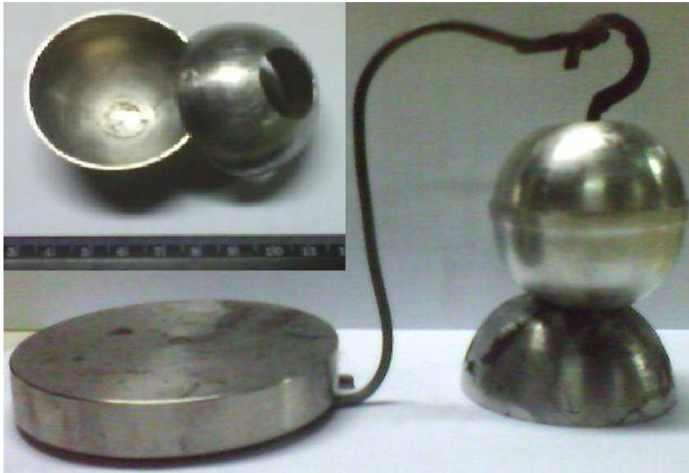
Figura 4.3. Molde de alumínio e processo utilizado para vazar mistura gel casting .
