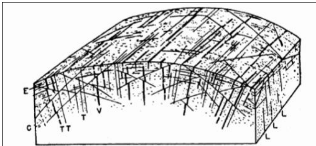
Figura 5: Algumas feições da estrutura de um plúton: T – diaclases transversais em relação a estrutura fluidal; L – diaclases longitudinais; E – diaclases paralelas às isotermas, podendo ser também produzidas pelo alívio de carga; C – diaclases de cisalhamento e V – diaclases preenchidas por meio de soluções ascendentes, constituindo os veeiros (LEINZ, 1966).
