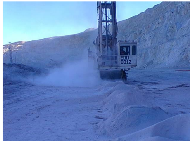
Figura 14: Exemplo de Erro de Extração por perda de material em perfuração.
