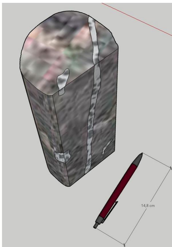
Figura 15: Representação de um testemunho de sondagem heterogêneo e irregular partido.
