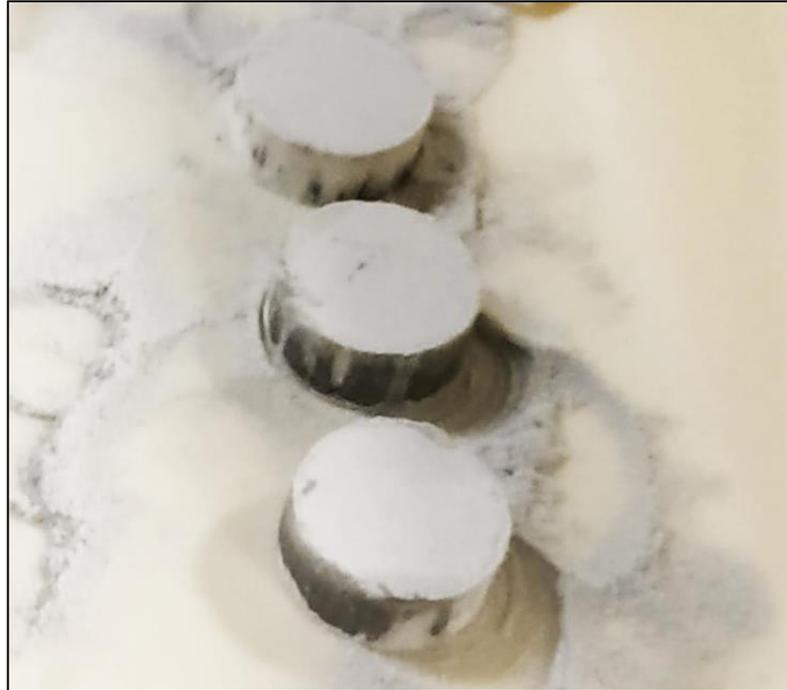
Figura 22. Foto do pó MA, após o processo de prensagem.
