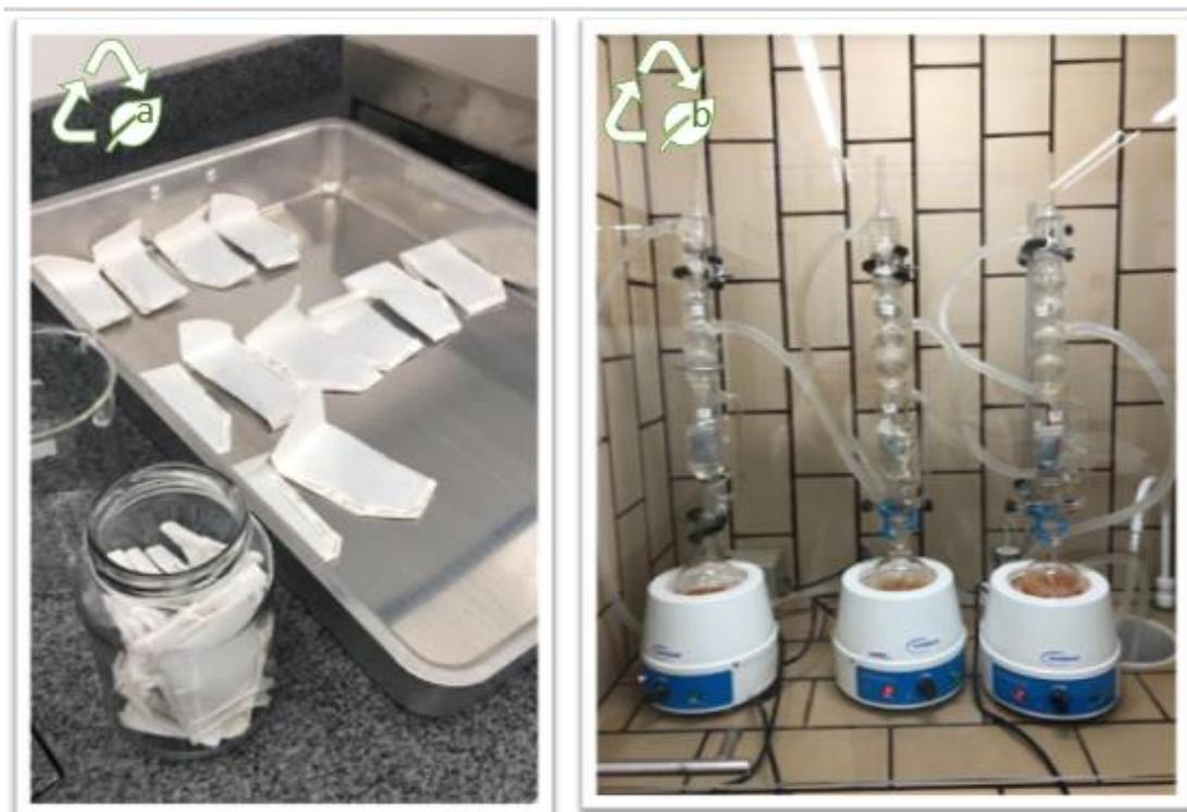
**Figura 34** - (a) Sacos de papel filtro submetidos a extrações em solvente (acetona / hexano), secos em estufa e pesados para determinação de teor de sol e gel (b) amostras em soxhlet em processo de extração com solvente polar.
