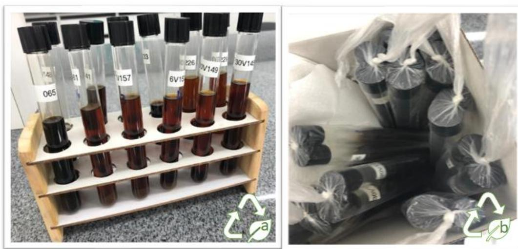
**Figura 37** - (a) amostras de extratos diluídas em hexano, destinadas a FTIR. (b) amostras de extratos embaladas em duplicatas para FTIR.
