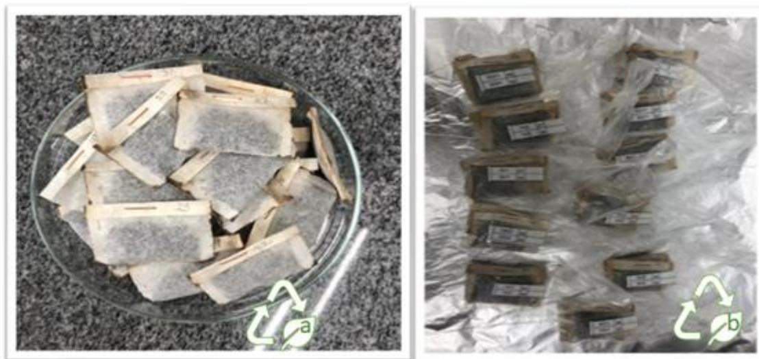
**Figura 32** - (a) amostras extraídas destinadas a TGA e DSC. (b) amostras embaladas em duplicatas para TGA e DSC.
