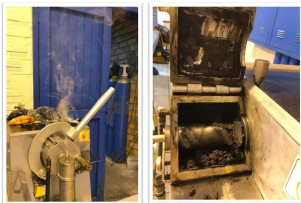
**Figura 38** - (a) Desprendimento de gases após 3 min de cisalhamento na velocidade 2. (b) Amostra 6V2 na saída da câmara.
