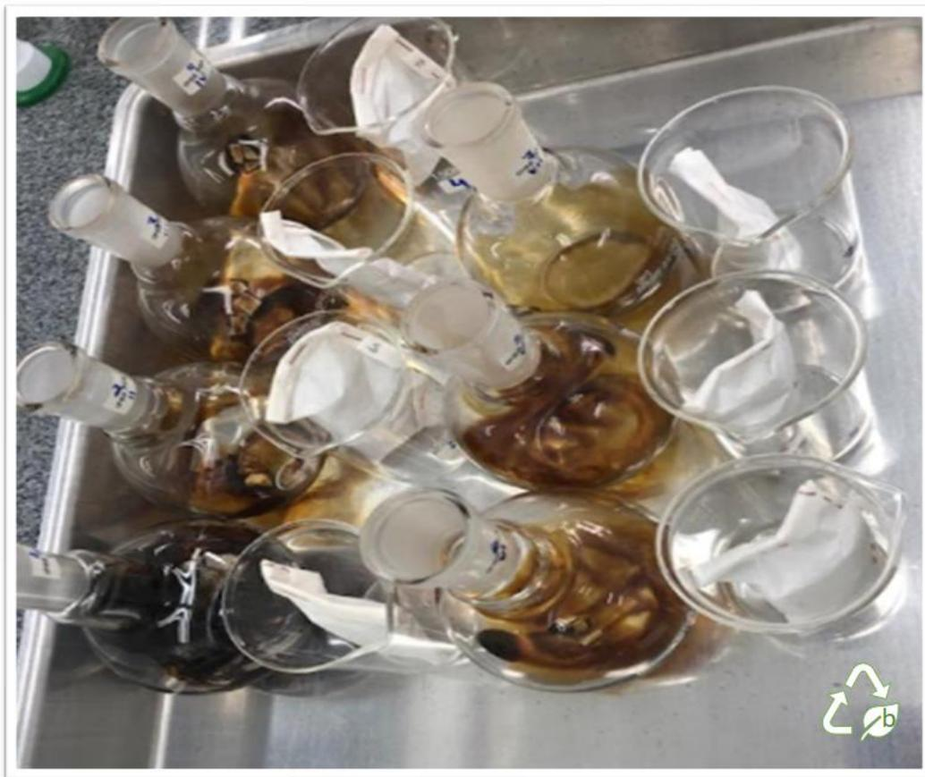
**Figura 35** - (a) amostras em soxhlet em processo de extração com solvente apolar. (b) Resíduo sol e gel após extração e evaporação do solvente.
