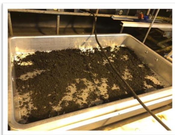
**Figura 30** - Amostra logo após desvulcanização, espalhada em bandeja metálica e esfriando até temperatura ambiente em capela de exaustão.
