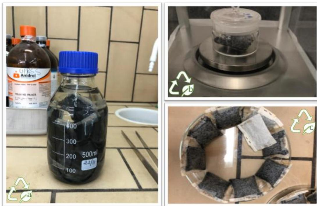
**Figura 36** - (a) Amostras intumescidas em tolueno. (b) Amostra intumescida pesada em pesa-filtro. (c) Amostras intumescidas em tolueno com grande diferença na quantidade de solvente ao redor dos grânulos de borracha.
