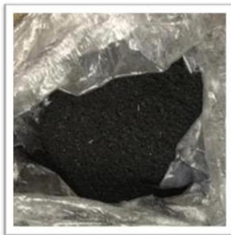
**Figura 28** - Amostra de pneu inservível moído obtida em malha industrial de aproximadamente 0,5 a 0,7 mm de granulometria.
