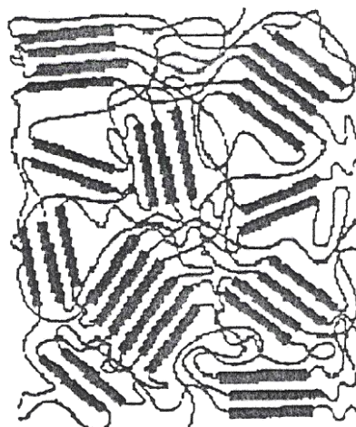
Figura 6. Modelo da “micela franjada” para a estrutura cristalina-amorfa de polímeros parcialmente cristalinos [47].
