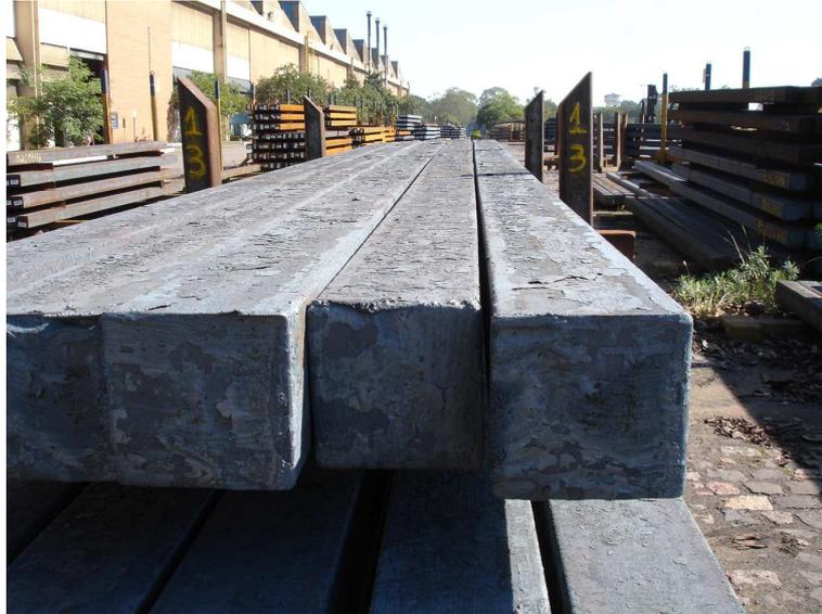
Figura 2.5: Cavalete com tarugos provenientes de lingotamento contínuo prontos para serem aplicados na laminação. Seção quadrada de 150mm com 6 metros de comprimento.
