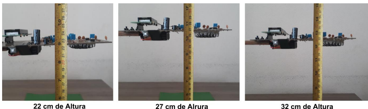
Figura 27 – Todo ilustrando o procedimento experimental para a realização das medições de NDVI com diferentes condições de altura.
