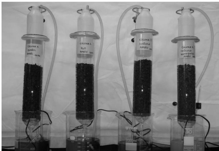
Figura 15. Reatores empregados nos ensaios de lixiviação.
