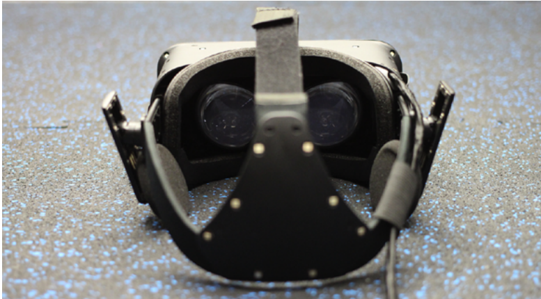
Figura 7. Vista traseira do Head Mounted Display com telas e fones
