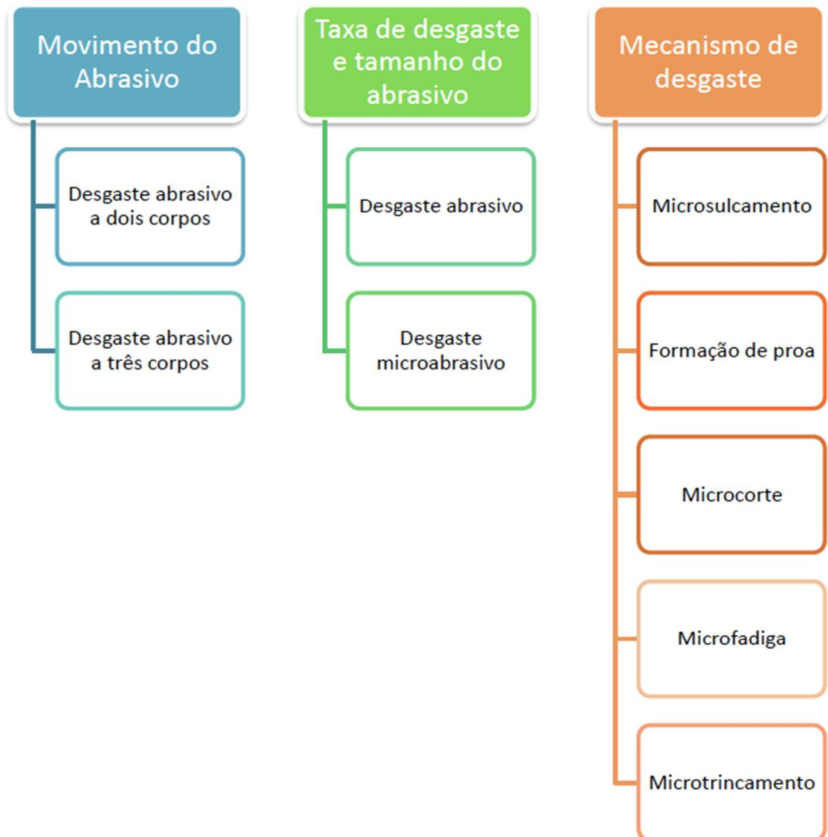
**Figura 8 Classificação do desgaste abrasivo. Fonte: adaptado de (COLOMBO; FARIAS; BERTI, 2011).**
