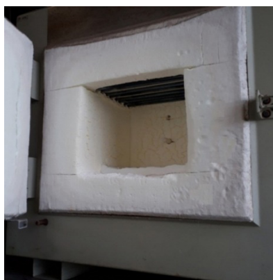
FIGURA 12.16 Forno de laboratório com resistência de SiC.
