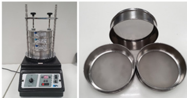
FIGURA 12.3 Mesa vibratória e peneiras. Determinação da distribuição granulométrica e do retido em peneira (resíduo).
