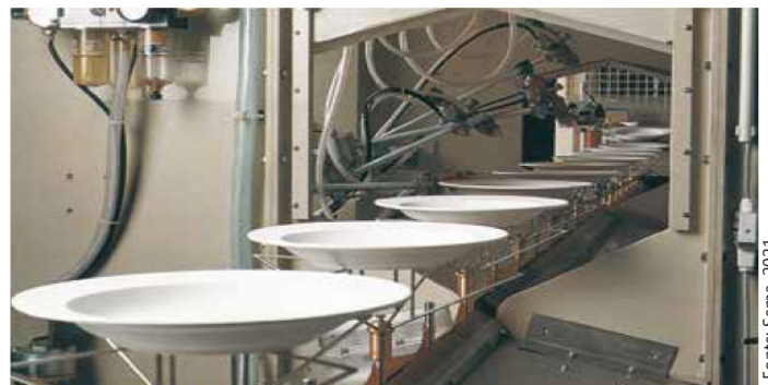
FIGURA 7.18 Processo de pulverização do esmalte.
