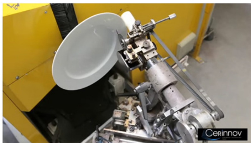
FIGURA 8.3 Máquina automática de filetagem.
