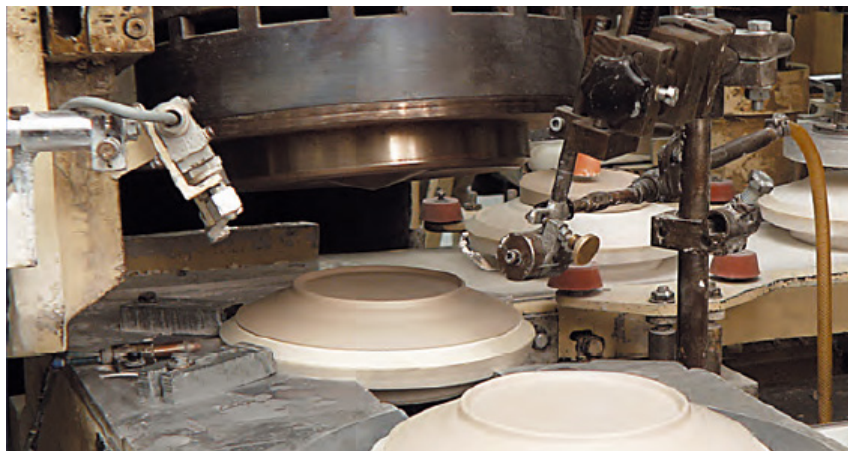
FIGURA 4.11 Ao fundo, a bolacha sobre o molde de gesso. À esquerda, a peça conformada sob o roller . Na frente, o molde e a peça sobre a esteira de transporte ao secador.
