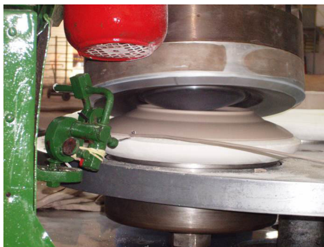
FIGURA 4.12 Detalhe na conformação de prato, com a saída do excesso de massa.
