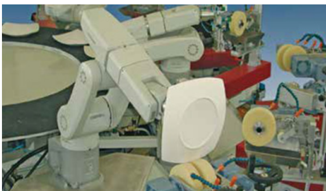
FIGURA 1.6 Esponjamento de um prato por robô.
