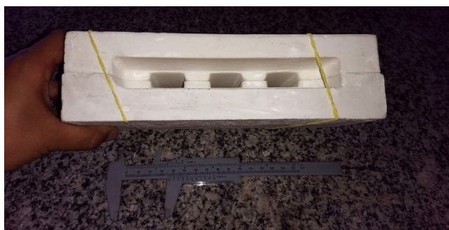
FIGURA 12.19 Molde de gesso para conformação de corpos de prova cerâmicos a partir de uma barbotina.
