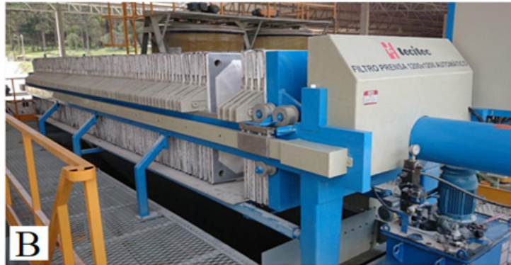
FIGURA 4.4 A: Esquema de filtro-prensa com as cabeças terminais e as placas filtrantes. B: Filtro-prensa.
