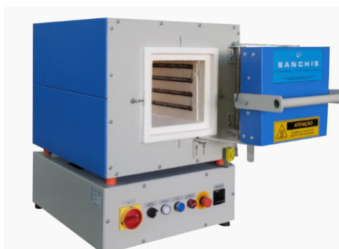
FIGURA 12.15 Forno de laboratório com resistência Kanthal®.
