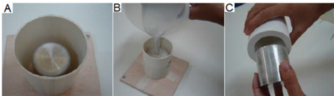
FIGURA 4.39 Etapas para fabricação do molde. A: Posicionamento da matriz. B: Vazamento do gesso. C: Remoção da matriz.
