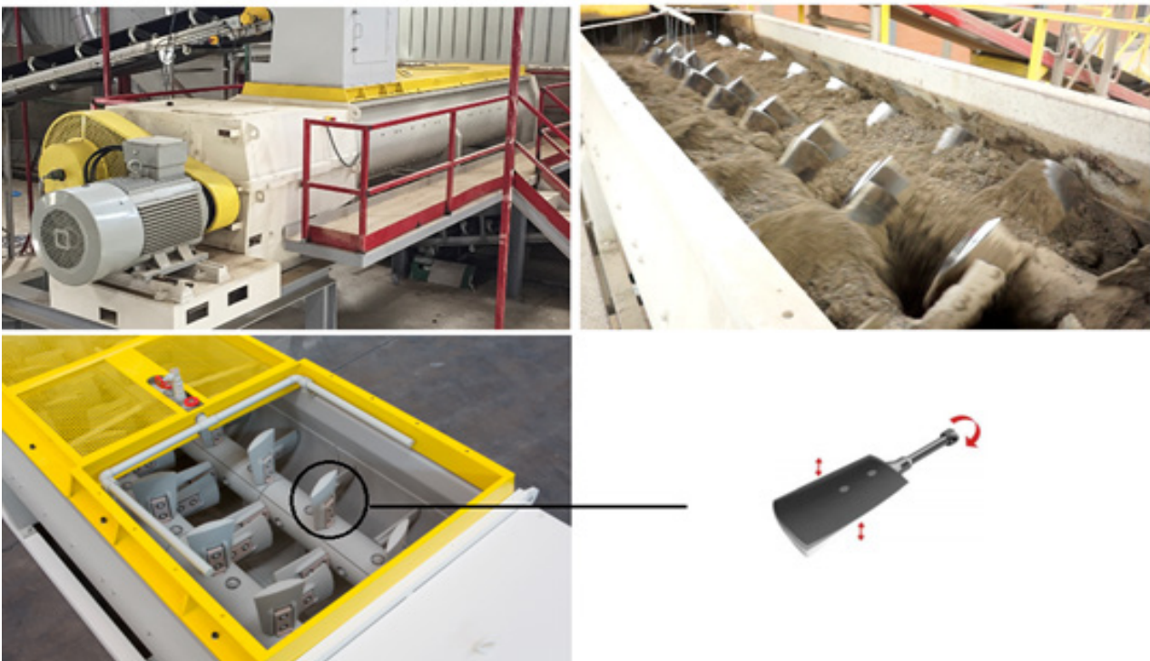
FIGURA 4.3 Misturadora de dupla rosca. Potência de 22 a 200 Wh e produção de 24 a 204 t/h (do menor ao maior modelo). Em detalhe a "pá" de mistura.
