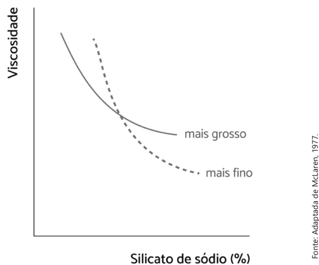
FIGURA 10.31 Efeito da fração intermediária mais fina ou mais grosseira (materiais não coloidais) sobre a viscosidade.
