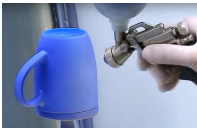
FIGURA 8.4 Aplicação manual de esmalte colorido por pistola.
