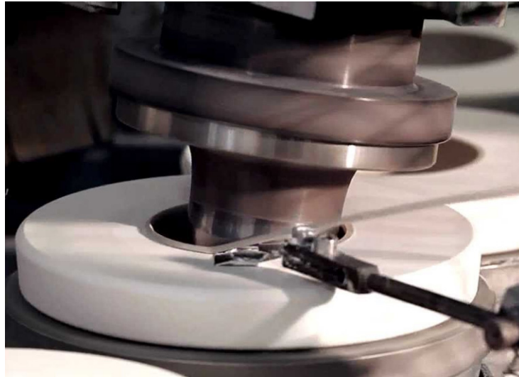
FIGURA 4.13 Detalhe na conformação de xícara, com a saída do excesso de massa.
