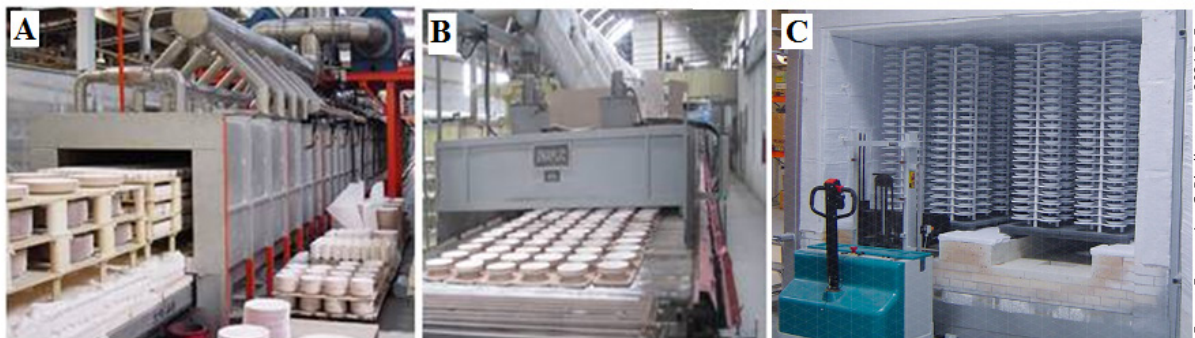
FIGURA 6.3 Primeira queima ou chacoatamento. (a) forno contínuo de vagonetas; (b) forno contínuo de rolos. (c) forno intermitente.
