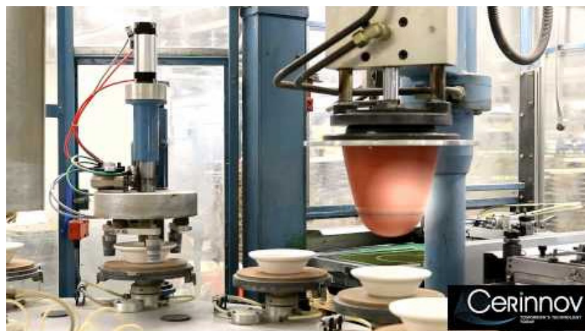
FIGURA 8.12 Serigrafia automatizada (tampografia), mostrando o tampão de silicone.
