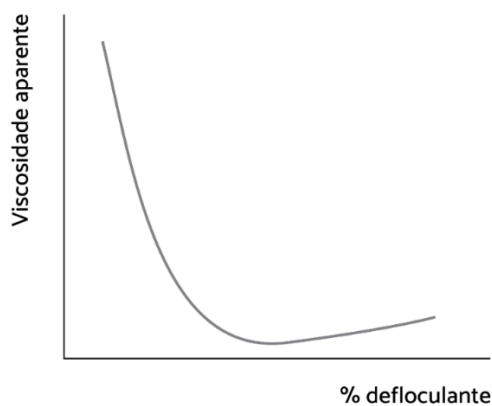
FIGURA 10.14 Comportamento da viscosidade em relação à adição de defloculante.
