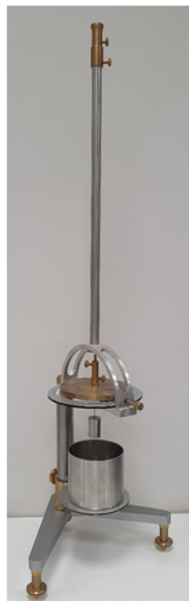
FIGURA 12.12 Gallenkamp ou viscosímetro de torção.
