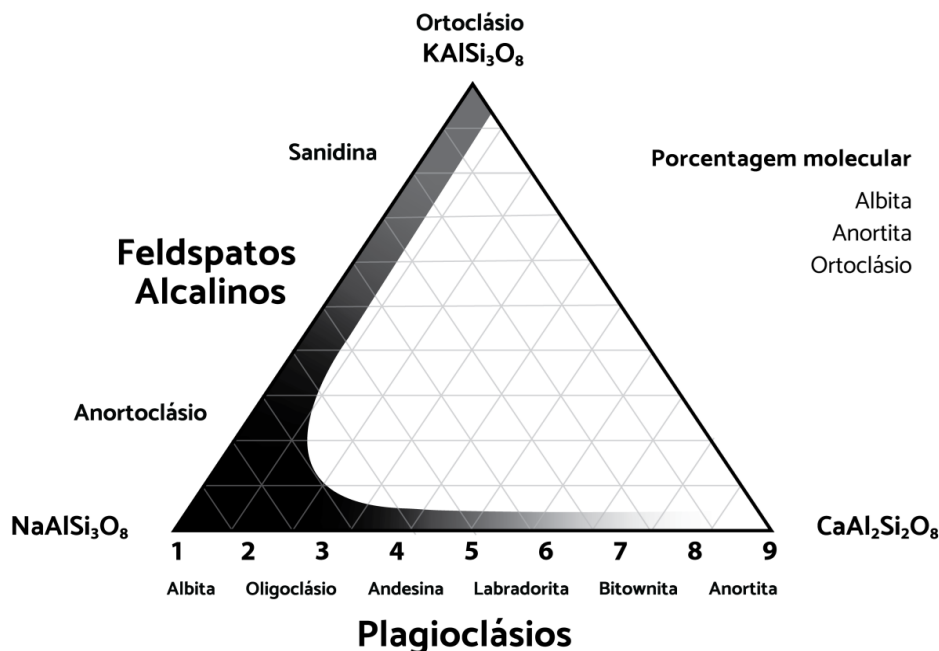
FIGURA 2.5 Composição dos feldspatos com base no diagrama Ortoclásio – Albita – Anortita.
