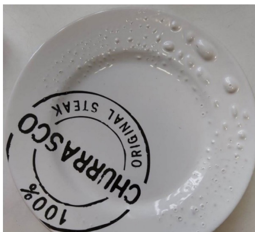
FIGURA 9.2 Bolhas sob o esmalte em prato, após a queima de massa contaminada com óleo da manutenção do roller .
