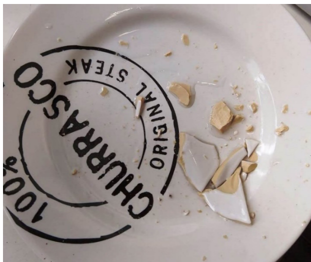
FIGURA 9.20 Explosão de peça com consequente contaminação das peças ao redor.
