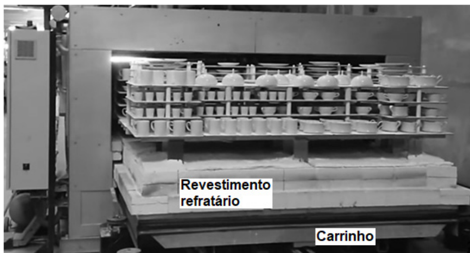
FIGURA 6.31 Detalhe das louças empilhadas em forno de vagonetas.
