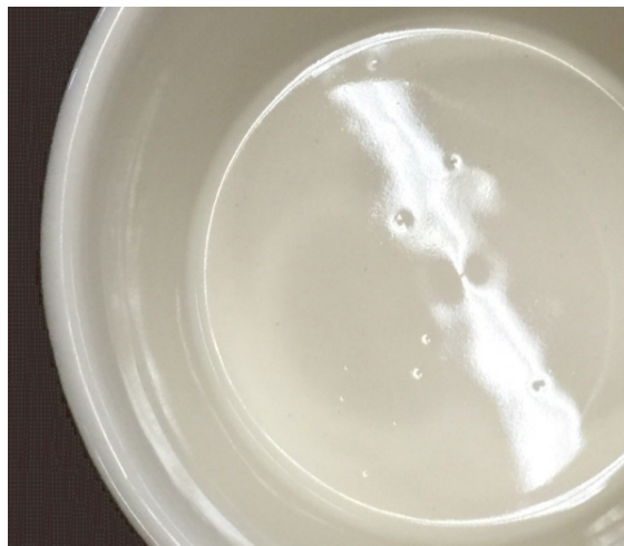
FIGURA 9.13 Ocorrência de pinholes em cerâmica de mesa.
