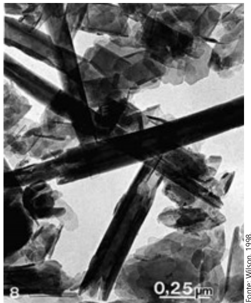
FIGURA 2.4 Micrografia eletrônica de transmissão (MET) de caulim haloisítico. A estrutura tubular da haloisita pode ser vista no centro da imagem.
