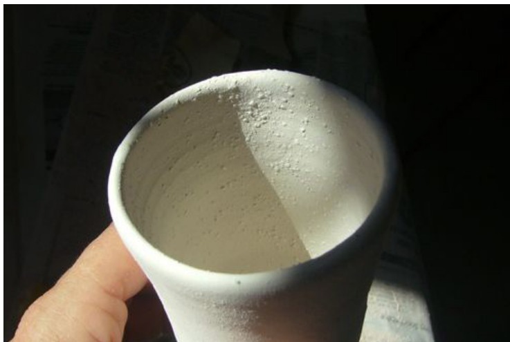
FIGURA 9.17 Grumos de esmalte depositados na superfície interna da peça esmaltada.
