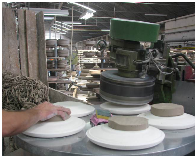
FIGURA 4.10 Roller, ou máquina para o torneamento com cabeçote rotativo ( roller head machine ), com carregamento manual.
