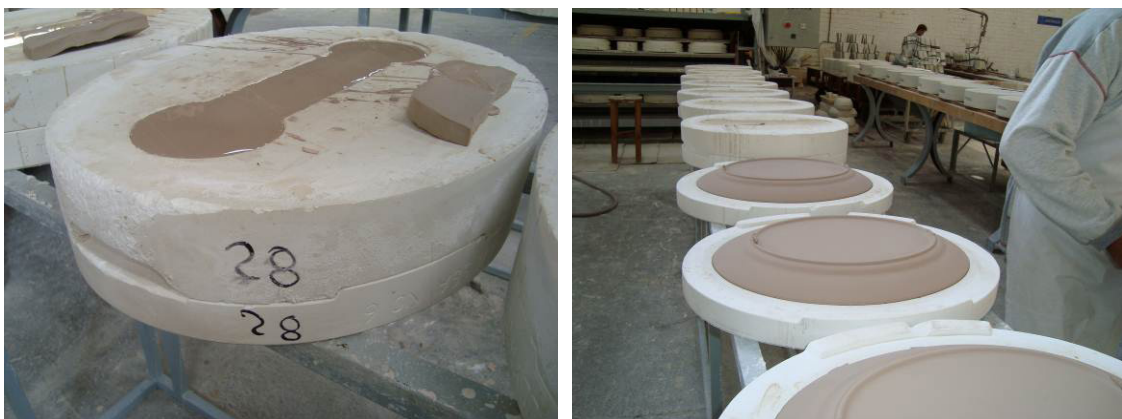
FIGURA 4.16 Conformação de travessas (molde fechado).
