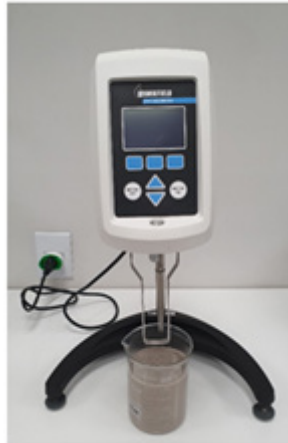
FIGURA 12.11 Viscosímetro da Brookfield.
