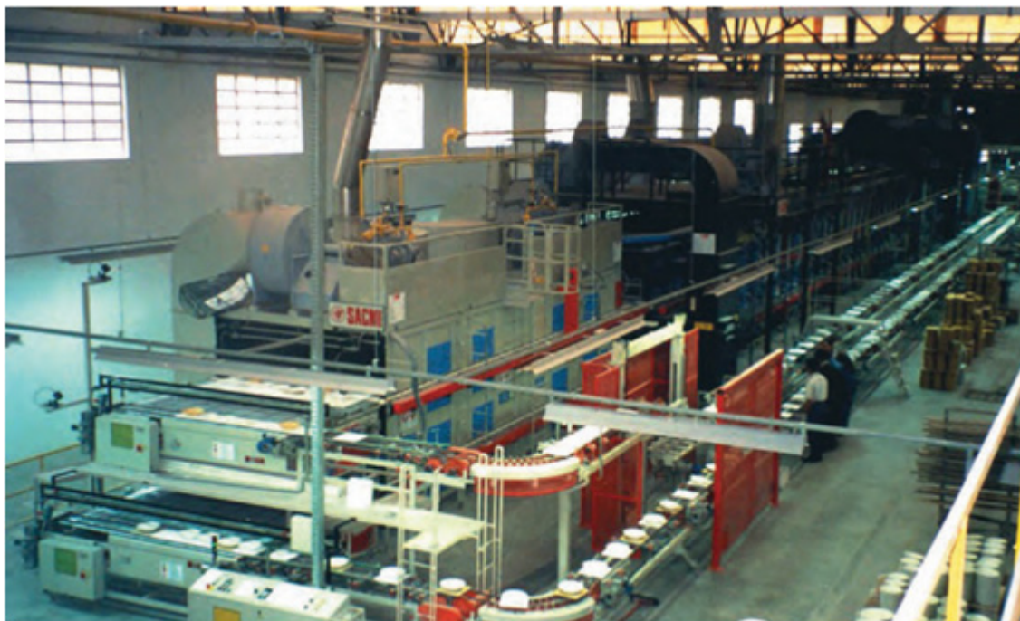
FIGURA 6.30 Forno a rolos de dois canais.
