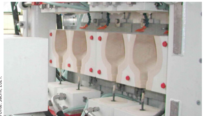
FIGURA 1.11 Máquina injetora para peças ocas com molde de garrafas cerâmicas.
