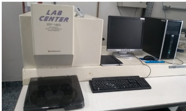
FIGURA 12.24 Equipamento de fluorescência de raios X.
