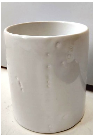
FIGURA 9.15 Peça queimada com falha de esmalte.
