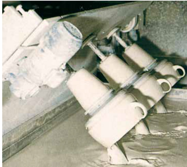
FIGURA 7.16 Processo de imersão no esmalte.
