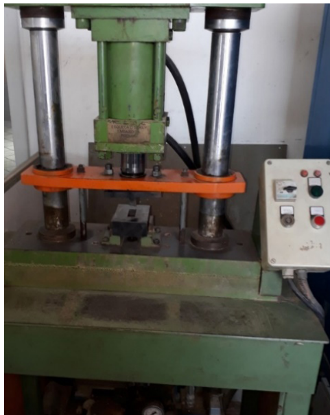
FIGURA 12.20 Prensa de laboratório para compactação de matérias-primas e massas cerâmicas.
