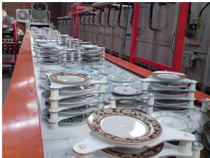
FIGURA 6.27 Pratos esmaltados apoiados sobre a mobília de forno após a queima.
