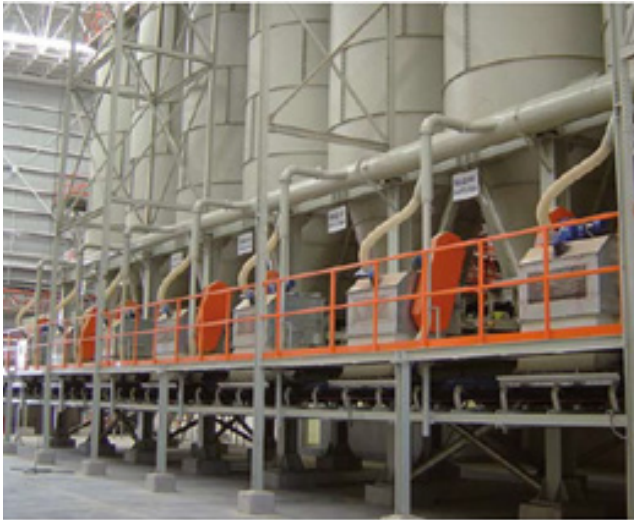
FIGURA 2.36 Silos de estocagem com unidade de pesagem.
