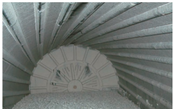
FIGURA 2.14 Moinho contínuo com linhas inclinadas dos ressaltos do revestimento de borracha.
