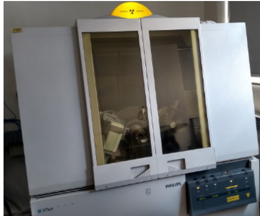
FIGURA 12.25 Equipamento de difração de raios X.
