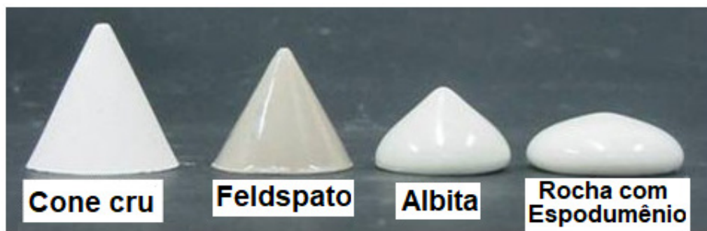
FIGURA 2.10 Cones de fusão das composições 100% K-feldspato, 100% de albita e 100% de rocha com espodumênio.
