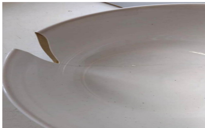
FIGURA 9.23 Quebra após queima do branco como consequência de batida da peça durante a enfora.
