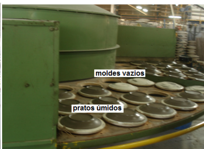
FIGURA 5.23 Secador contínuo circular mostrando os pratos úmidos nos moldes de gesso.
