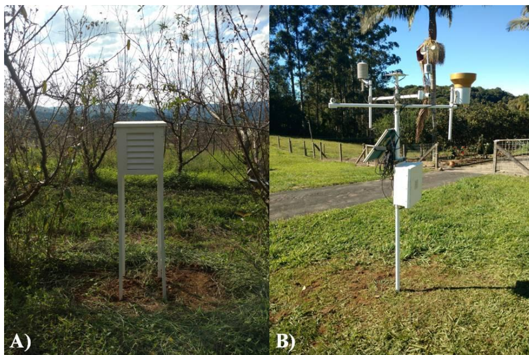
FIGURA 2. Estações meteorológicas. (A) Abrigo para datalogger da área Masiero. (B) Estação meteorológica convencional da área Marangoni. Foto: Autora, Urussanga (2020).
