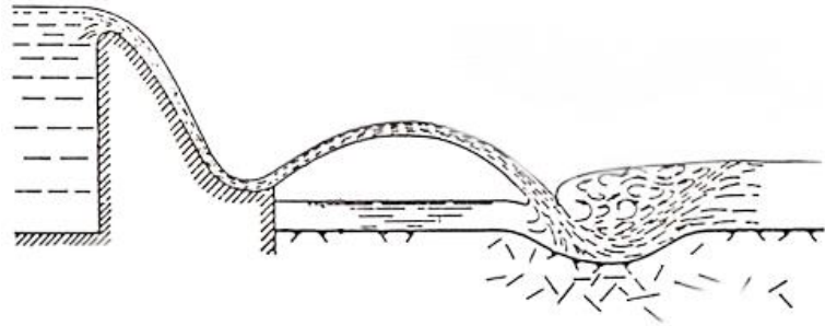
Figura 3: Representação esquemática de um vertedouro com salto esqui (fonte: adaptado de Yuditiskii (1983).
