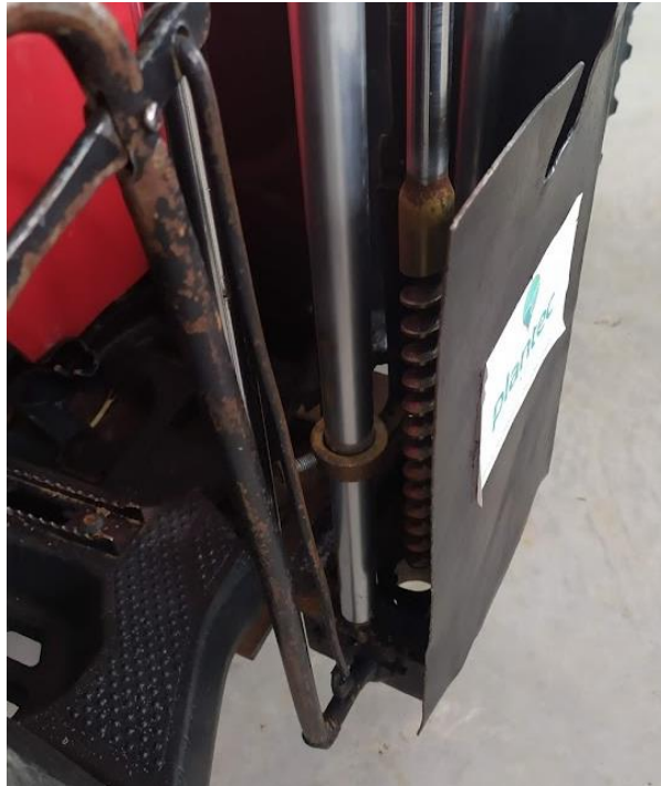
Figura 3: Detalhe de uma das brocas utilizadas e, à esquerda, o anel limitador de profundidade.
