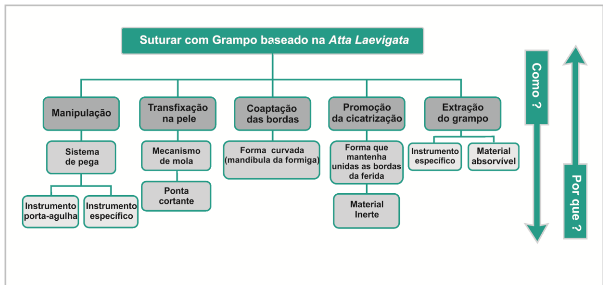
Figura 57 - Árvore funcional do sistema de sutura através da mandíbula formiga Atta laevigata
