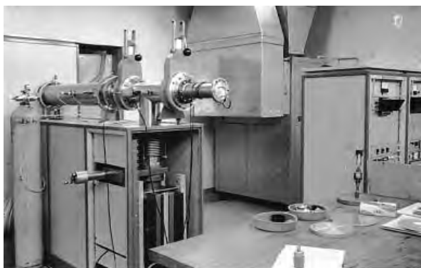
Primeiro tubo de aceleração do implantador de 400 kV. É o início da instalação do equipamento, antes da montagem das câmeras de análise.
