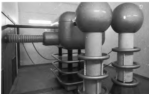
Fonte de alta tensão e fonte de íons do implantador de 400 quilovolts (kV), inaugurado em 1983. Depois a tensão foi aumentada para 500 kV.
