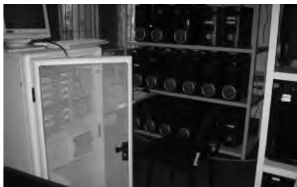
Computador Cobra 1400, baseado no Data General Eclipse MV400. A partir da esquerda: CPU, unidade para cópia de segurança, unidade com fita magnética e disco de 440 MB e mais uma unidade de disco. Ao fundo, o estoque de fitas magnéticas. À direita, sala com os terminais.
