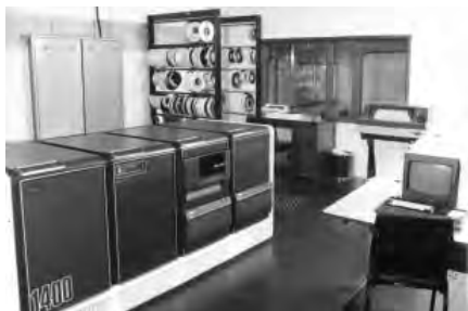
Computador Cobra 1400, baseado no Data General Eclipse MV400. A partir da esquerda: CPU, unidade para cópia de segurança, unidade com fita magnética e disco de 440 MB e mais uma unidade de disco. Ao fundo, o estoque de fitas magnéticas. À direita, sala com os terminais.
