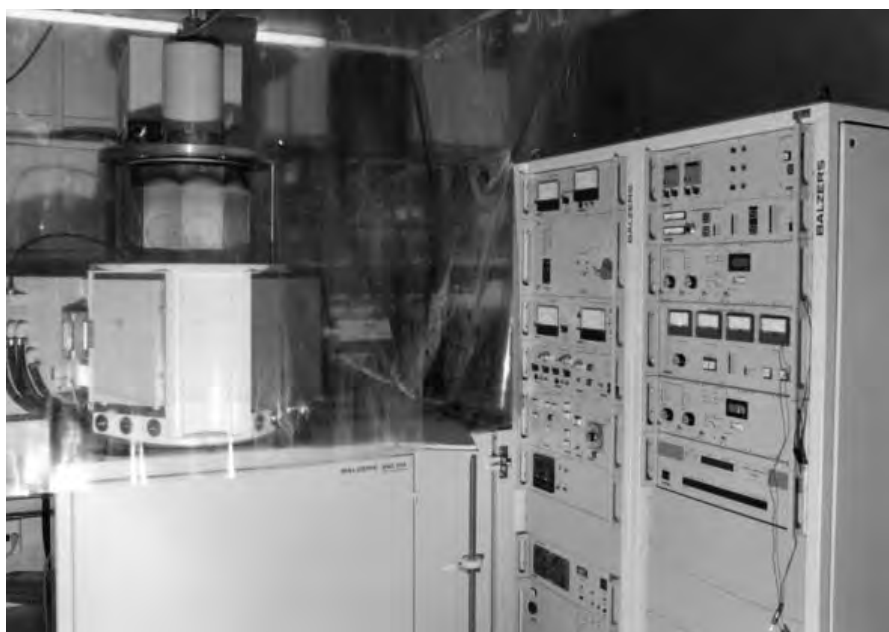
Primeiro sistema para fabricação de filmes finos do IF, adquirido da Balzers no final dos 1980.
