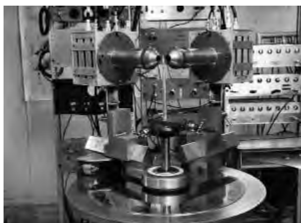
Laboratório de Correlação Angular. No primeiro plano, duas máquinas de teletipo para extração de dados experimentais. No detalhe abaixo, o porta-amostra no centro e os dois detectores de radiação.
