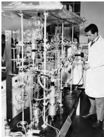
Linha de alto vácuo, 1957. O desenvolvimento de tecnologia de alto vácuo foi reiteradamente sugerido pelo professor Gerard Hepp. Na sua opinião, o CPF não poderia desenvolver pesquisa experimental de bom nível se não dominasse essa tecnologia.
