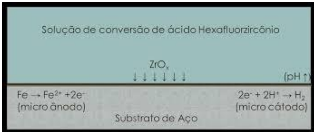
Figura 3. Mecanismo de formação da camada nanocerâmica no substrato. Exemplo com solução de conversão contendo hexafluorzircônio (4).
