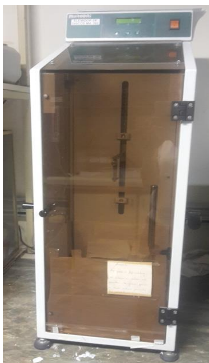
Figura 12. Foto do dip-coating do laboratório - LACOR-UFRGS.
