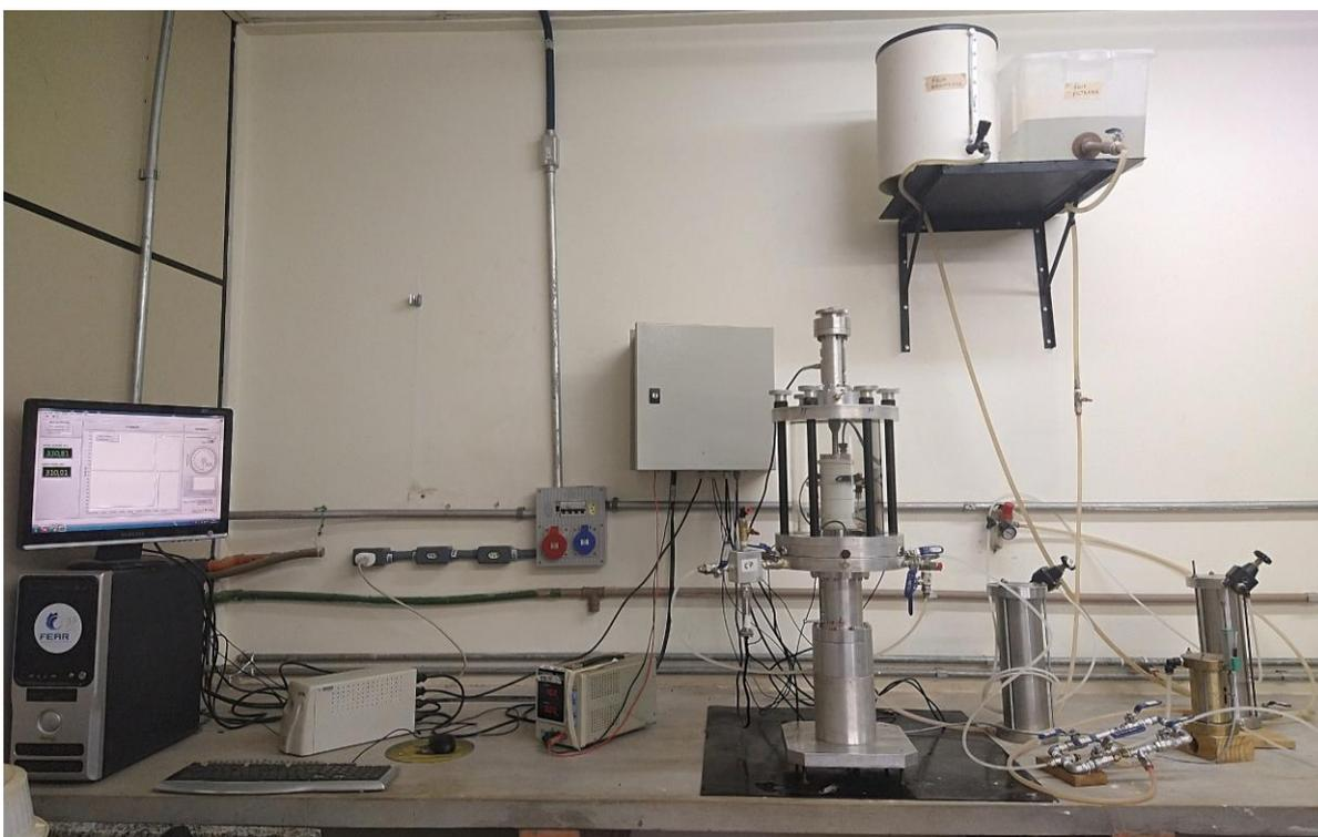
Figura 3.20: Equipamento de ensaio triaxial.
