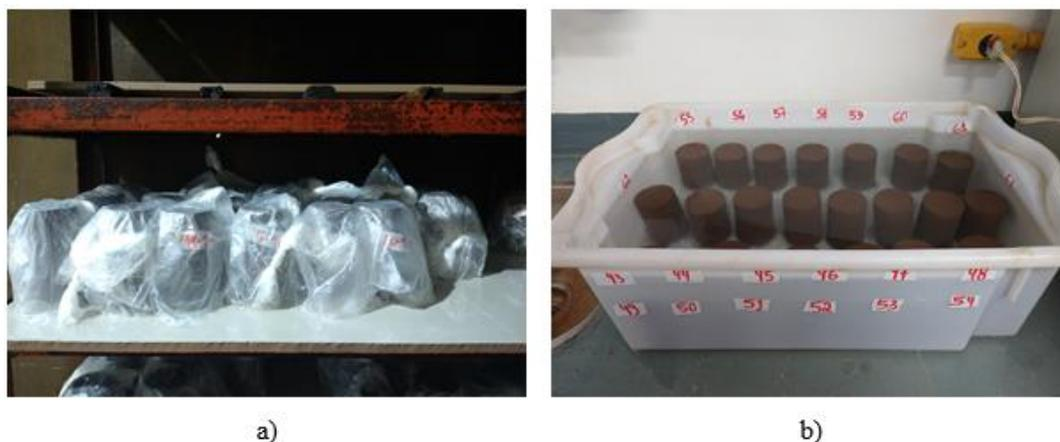
Figura 3.18:Corpos de prova em: a) estufa curando; b) imersão.
