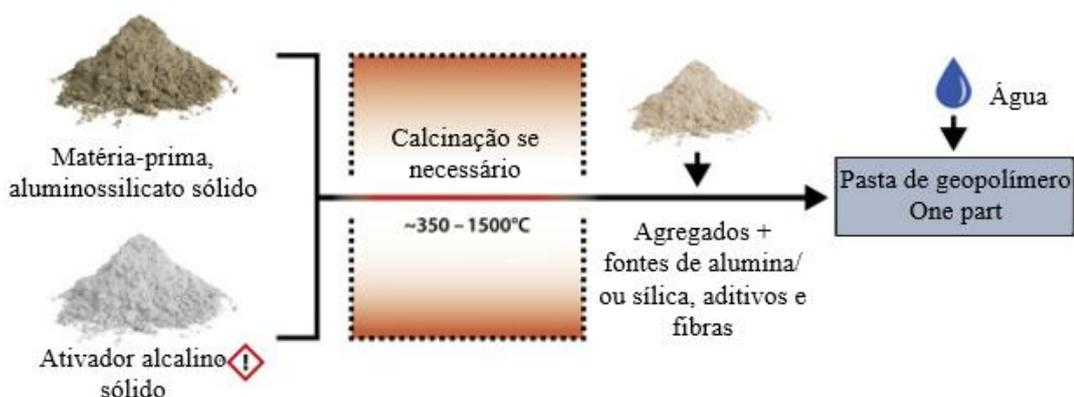
Figura 2.25: O procedimento geral de preparação de geopolímero de uma parte (Adaptado de LUUKKONEN *et al.*, 2018).
