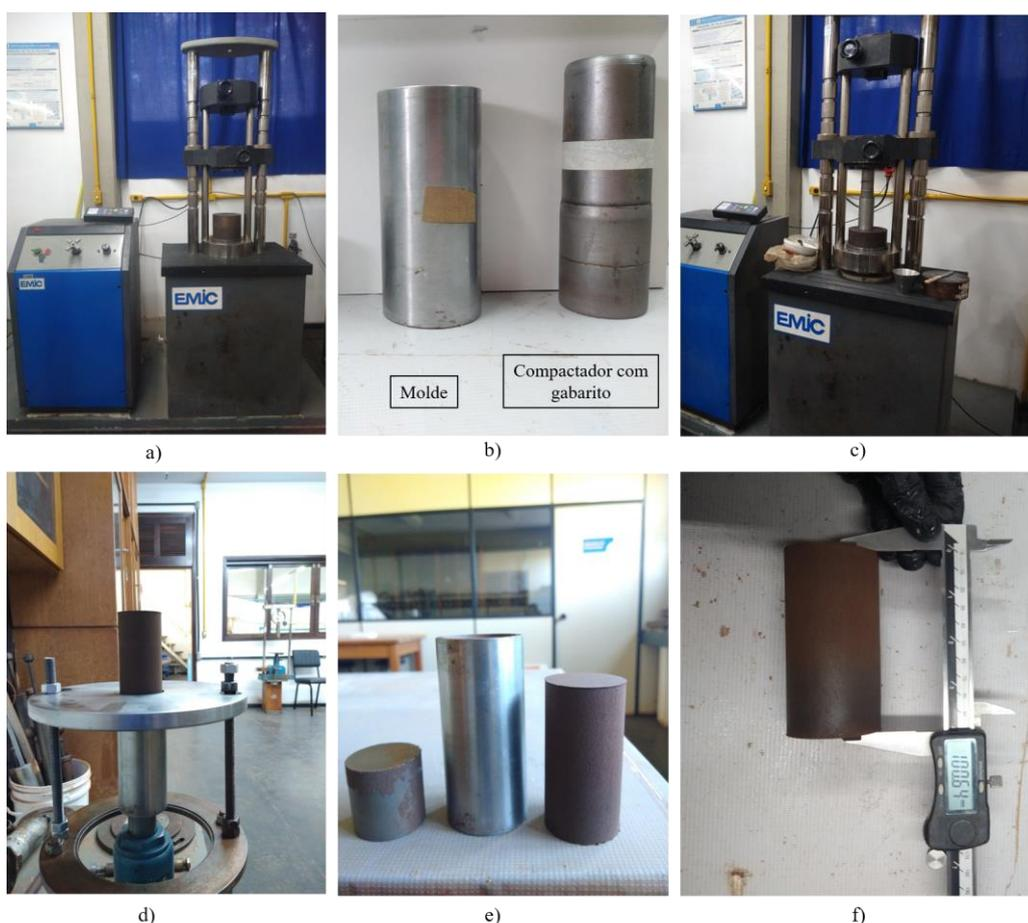
Figura 3.16: Obtenção dos corpos de prova: a) prensa hidráulica; b) molde e compactador; c) moldagem; d) extração e) corpo de prova extraído; f) aferição das medidas.
