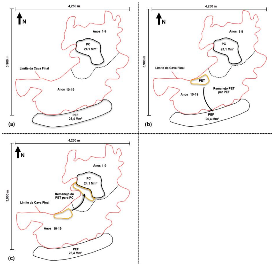
Figura 6-1 – Representação dos três cenários considerados, de acordo com a PEF: caso base (a); MSDS_1 com remanejo para PEF (b); e MSDS_2 com deposição em cava (c). O polígono vermelho representa o limite da cava final, polígonos pretos são a PC e PEF e a linha tracejada preta divide o sequenciamento da mina entre anos 1-9 (deposição na PC) e anos 10-19 (deposição na PEF).
