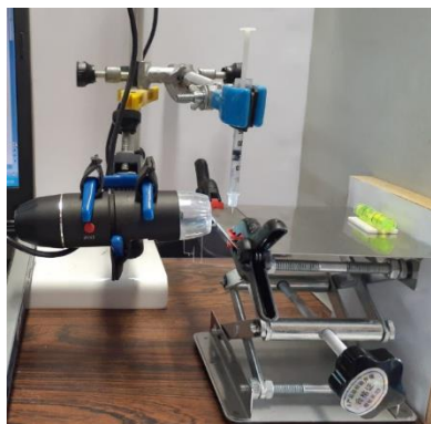
(a) Aparato desenvolvido no LAMATES/UFRGS para medidas dos ângulos de contato.
