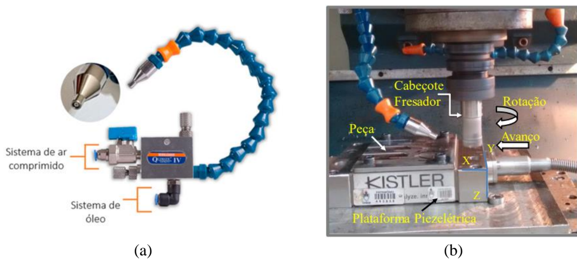
Figura 3.4 – Sistema RQL: (a) nebulizador IV; (b) posição do bico [Sória, 2016].
