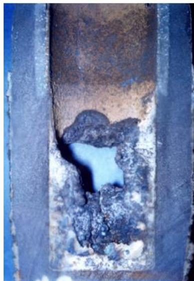
**Figura 10.** *Clogging* de alumina em uma válvula submersa. Fonte: POIRIER, 2015
