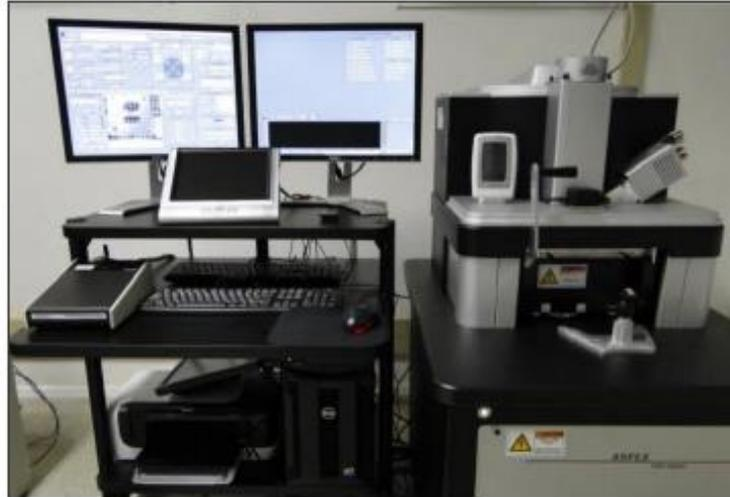
**Figura 37.** Microscópio *ASPEX* empregado na análise inclusionária deste trabalho.
