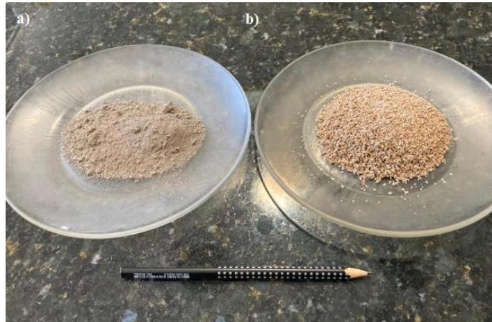
**Figura 28.** Materiais refratários utilizados para o estudo. a) Massa *spray*, de projeção b) Massa seca.
