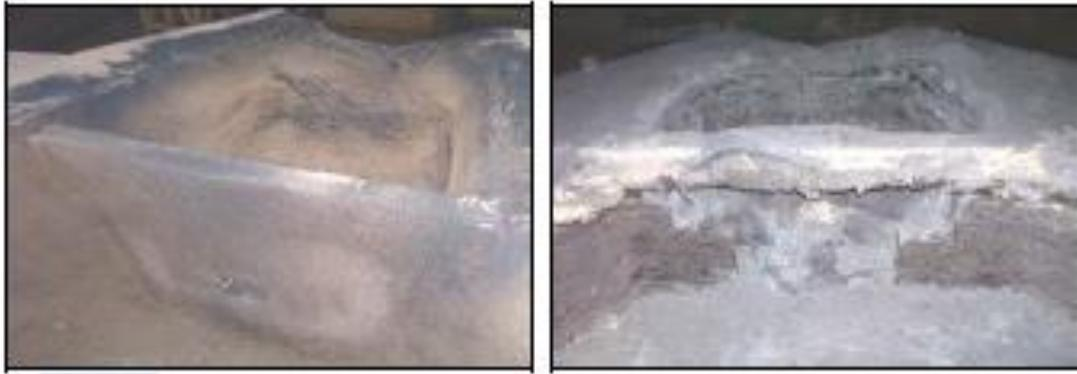
**Figura 11.** Barreiras de DT novas (à esquerda) e usadas (à direita).
