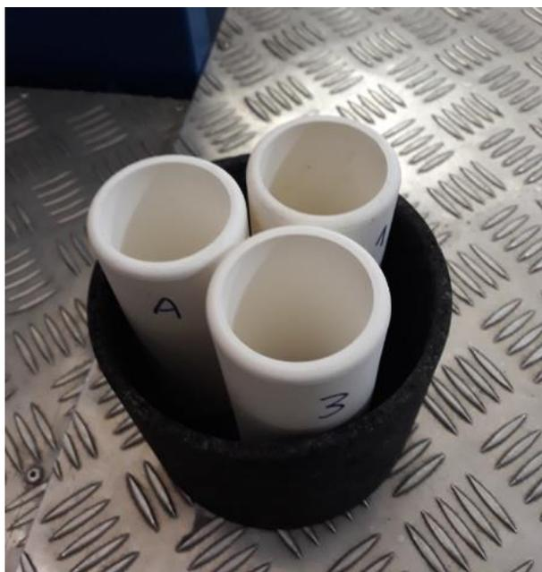
**Figura 36.** Cadinhos de MgO ( $h = 100$  mm,  $d_{\text{ext}} = 40$  mm e  $d_{\text{int}} = 35$  mm) utilizados nos experimentos para comparação da limpeza com uso de aço na forma de barra usinada/serrada ou *lollipop*.
