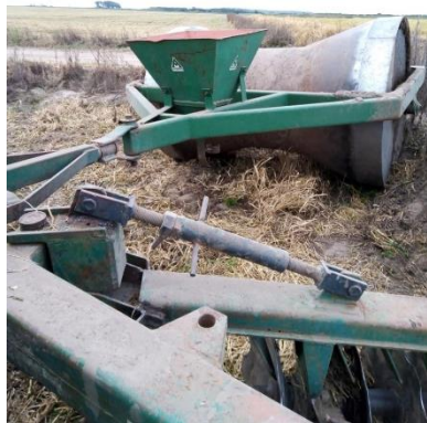
Figura 13 - Semeadora acoplada a entaipadeira. Fazenda Cavahada, Mostardas.
