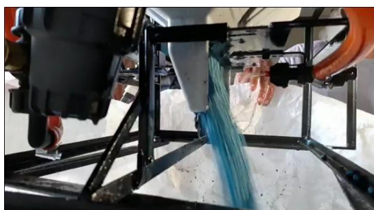
Figura 3 - Máquina inoculando sementes de soja. Fazenda Nova, Palmares do Sul.
