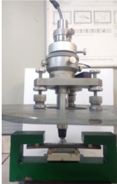
Figura 19 – Montagem do dispositivo de flexão em quatro pontos abaixo da bancada do MFC para determinar tensão efetiva.
