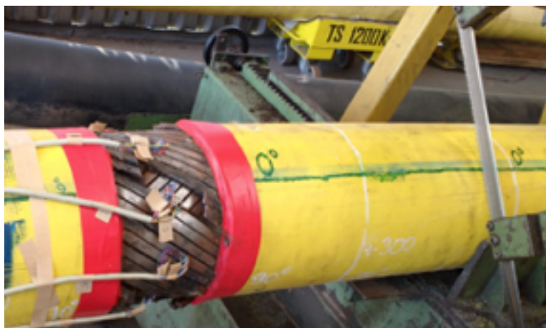
Figura 21 - Seccionamento da amostra com monitoramento de deformação da armadura externa e interna.
