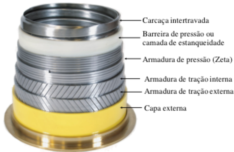
Figura 4 – Configuração típica de dutos flexíveis e identificação de suas diversas camadas
