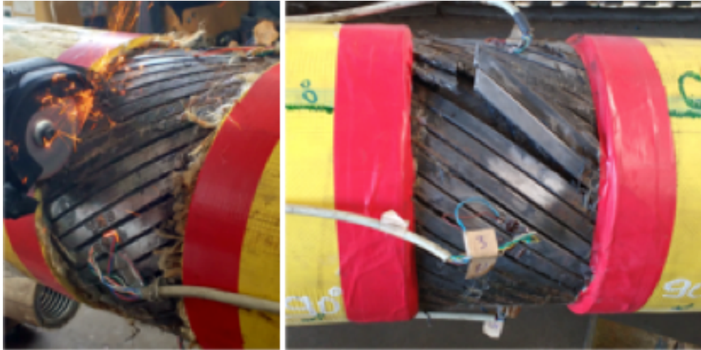
Figura 21 - Abertura da janela para acesso à armadura interna.
