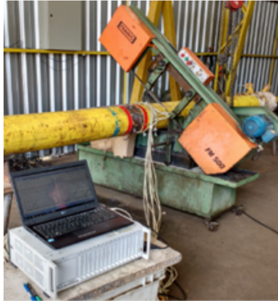
Figura 20 - Ensaio de monitoramento do alívio de tensão.
