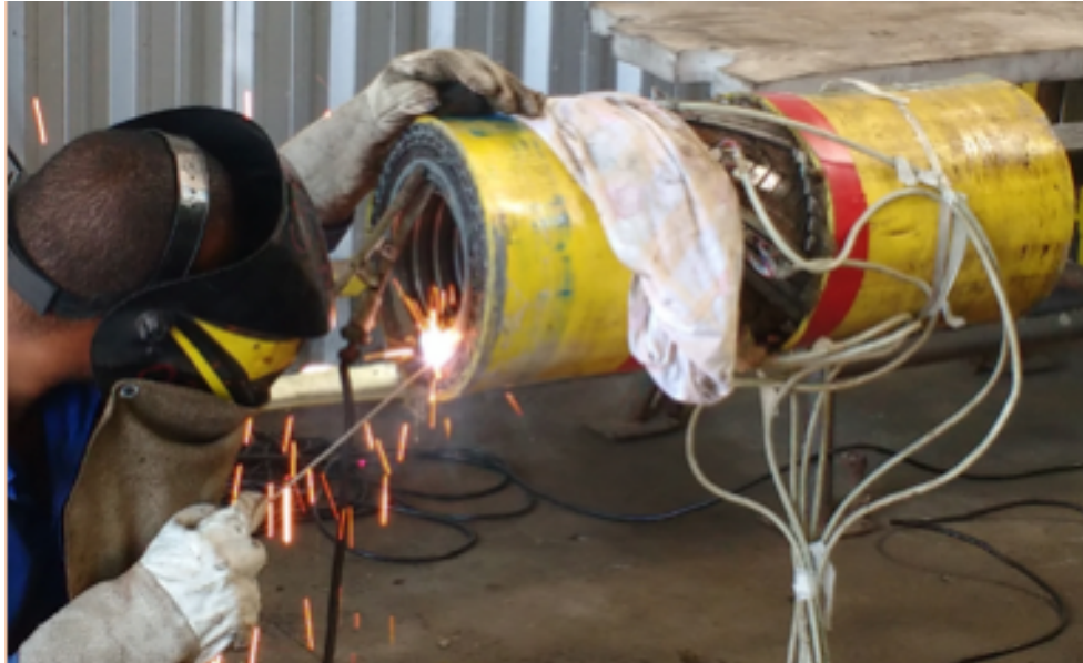
Figura 22 – Soldagem da camada Zeta.
