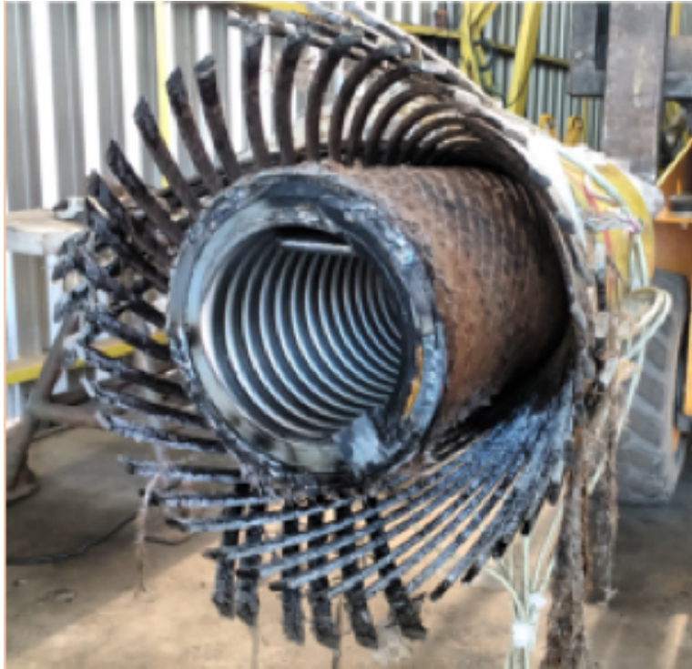
Figura 24 – Amostra após a remoção de um dos lados da capa externa.
