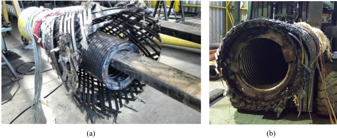
Figura 74 – Retorno elástico dos arames da armadura de tração após retirada da capa polimérica, (a) Amostra 3 e (b) Amostra 4.
