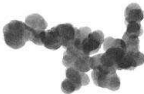
Figura 3-1 Imagem de microscopia eletrônica de uma partícula de negro de fumo [Carbon black, 2001].
