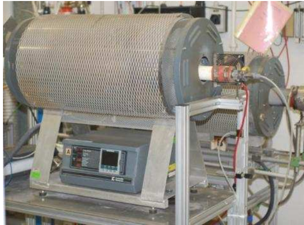
Figura 3-16 Forno tubular usado para a remoção do ligante e do material provisório quando o NF foi usado.
